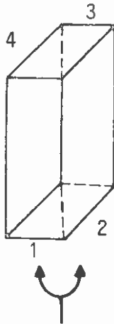
Kuva 6. Ruiskutus-suunta ja koekappaleen sivujen numerointi.
