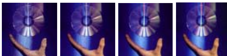
Kuva 18. Esimerkkikuvat GIF-muodossa 8-, 16-, 64- ja 256-värisinä (150 dpi). Tiedostojen koot ovat vastaavasti 6 kb, 8 kb, 13 kb ja 21 kb.
