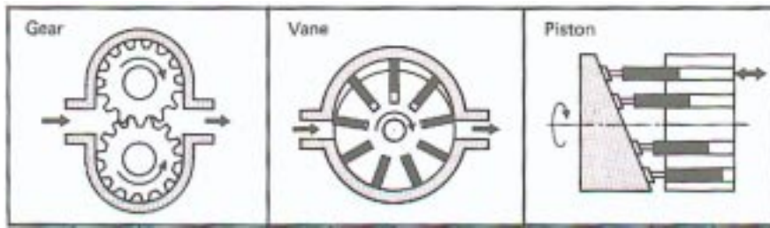
Kuva 10. Hammaspyörä-, siipi- ja mäntäpumpun toimintaperiaatekuva [23].
