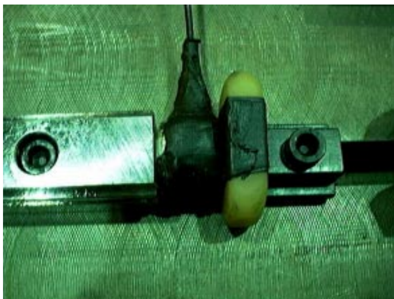
Kuva 5. AE-anturin kiinnitys lineaarijohteen päässä.
