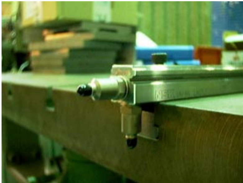
Kuva 3. Kiihtyvyyssantureiden kiinnitys lineaarijohteen päässä.
