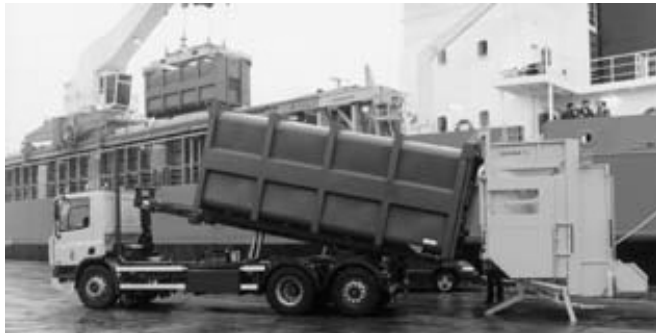
Kuva 13. Kontin siirto keräysajoneuvosta sekä konttien kuljetusta täysperävaunuyhdistelmällä. (Geesink-Norba Group 2001)
