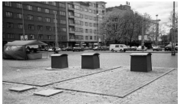
Kuva 6. Maan alle laskettava jätessäiliö on esteettinen ja tilaa säästävää ratkaisu kaupunkiolosuhteisiin. (Ecosir-Invest Oy 2001)
