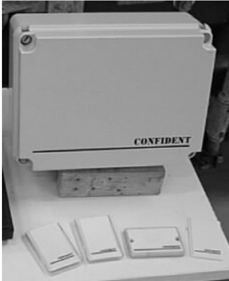
Kuva 9. Tagmaster Confident lukija ja saattomuisteja. (Permala et al. 2000)
