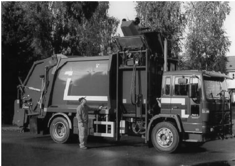
Kuva 12. Norban varustama pakkaava jäteauto sivulastaajalla. (Flaaming 2001)
