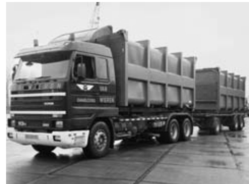
Kuva 13. Kontin siirto keräysajoneuvosta sekä konttien kuljetusta täysperävaunuyhdistelmällä. (Geesink-Norba Group 2001)
