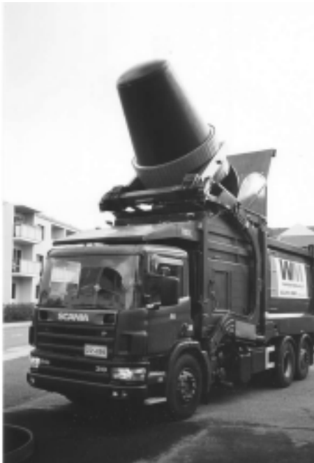
Kuva 8. Uppo-syväsäiliön tyhjentäminen etulastausautolla.
