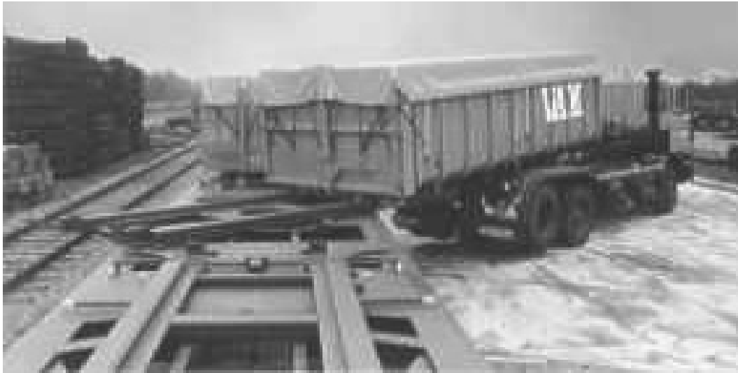
Kuva 15. Kuljetusyksikön siirtoa rautatievaunusta kuorma-autoon ACTS-järjestelmällä. (ACTS Nederland bv)
