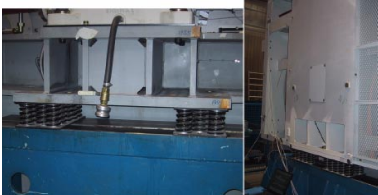
Kuva 2. Jousista koostuvat tukielementit N-pään palkin alla (vasen kuva) ja vasemmalla sivulla (oikea kuva).
