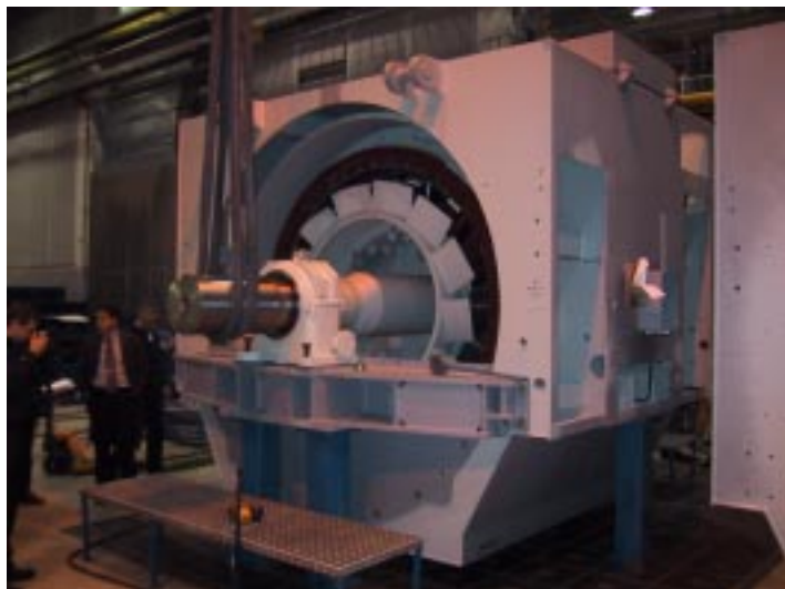
Kuva 1. Generaattori tuotantolinjalla ennen koeajoa.
