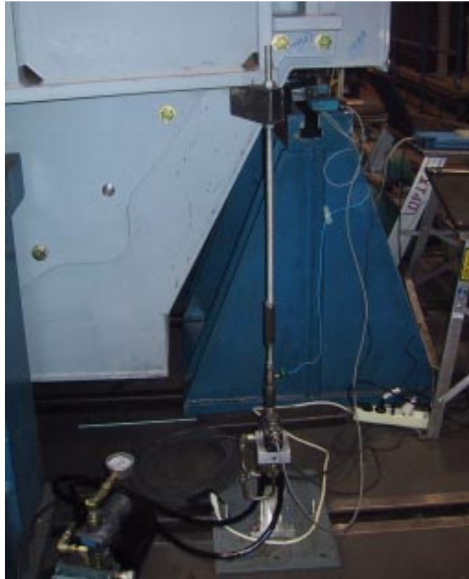
Kuva 3. Hydraulinen tärustin oli kiinnitetty lattiaan. Herättävä voima tuotiin tangon avulla N-pään vasempaan alanurkkaan. Herätevoima mitattiin tangon alapäästä.
