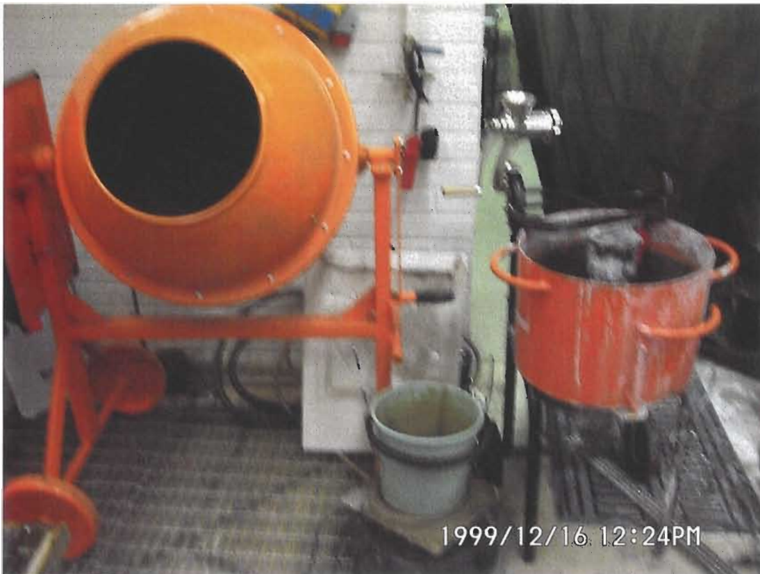
Kuva 1. Esikokeissa käytetyt koelaitteet: vasemmalta betonimylly, lihamylly ja tasosekoitin.
