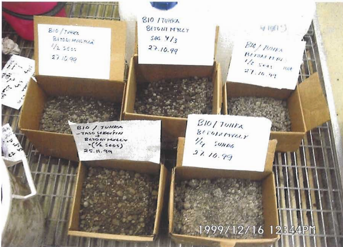
Kuva 2. Betoninsekoittajalla tehdyissä esikokeissa saatuja rakeita
