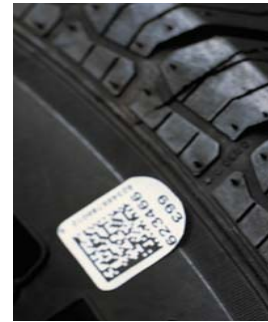
Kuva 4: Intermec'in B-11 yhteensopiva saattomuisti, jossa lisäksi Data Matrix koodi (www.intermec.com)
