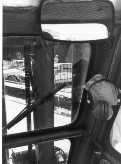
Kuva 7. Trukin rakenteet haittaavat näkyvyyttä trukista (Kuva: Tapaturmavakuutuslaitosten liitto).
