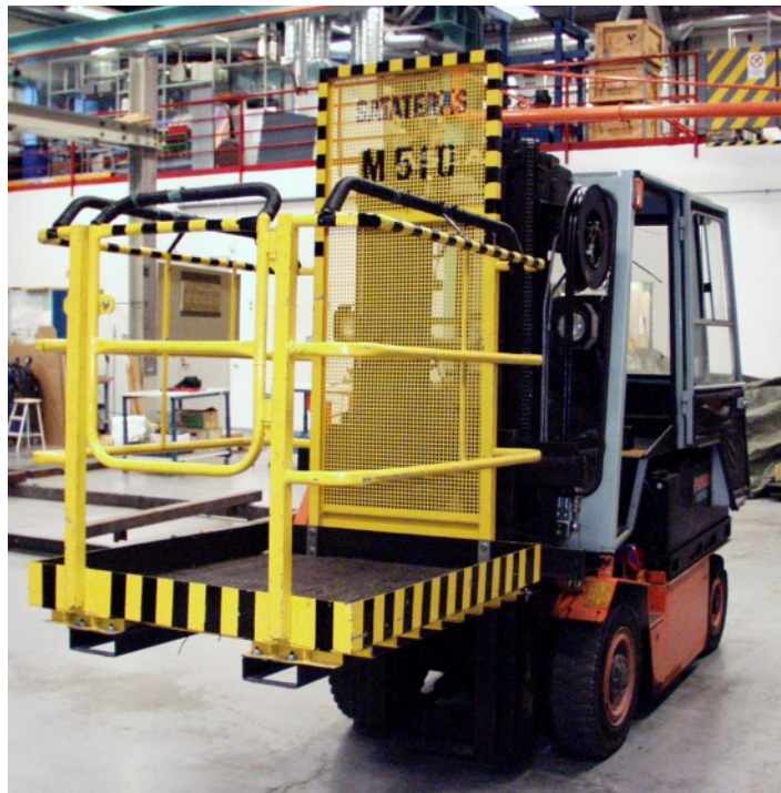
Kuva 13. Esimerkki henkilönostoissa käytettävästä henkilönostokorista (kuva: VTT Tuotteet ja tuotanto).
