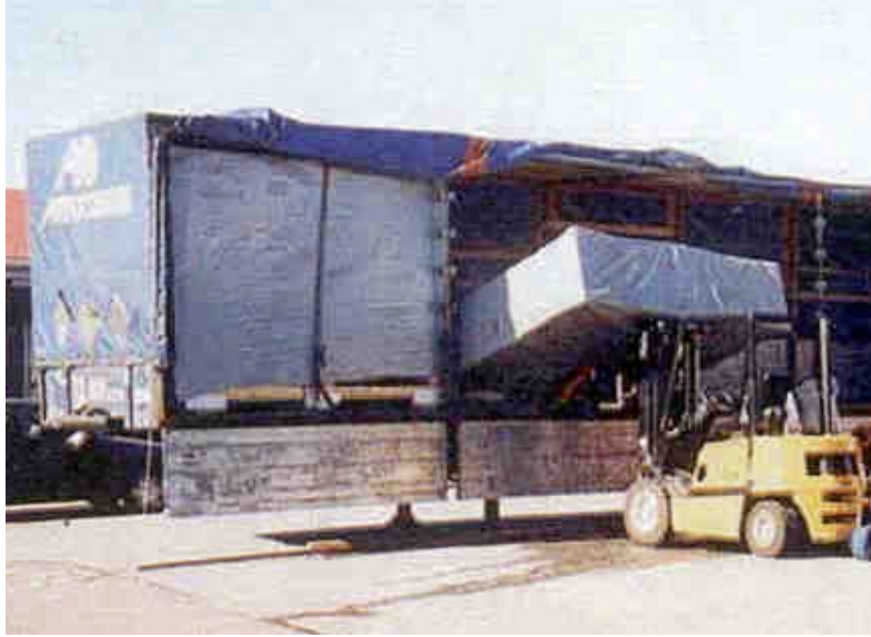
Kuva 10. Trukin nostokyky ei riittänyt purkamiseen yhdeltä puolelta ja kuorma siirrettiin pumppukärryllä lähemmäksi reunaa (Kuva: Tapaturmavakuutuslaitosten liitto).
