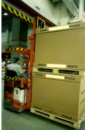
Kuva 9. Ajo masto nostetussa asennossa, jolloin trukki ei mahdu oviaukosta (Kuva: Tapaturmavakuutuslaitosten liitto).
