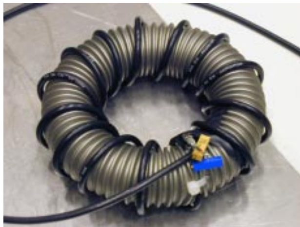
Kuva 2.6.5. Tutkimuksen aikana kehitetty Rogowski-anturi osittaispurkausmittauksiin.
