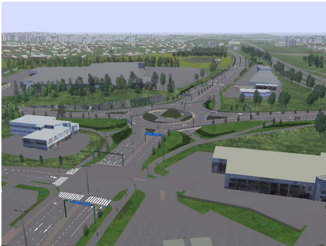
Kuva 22. Kaupunki-infrastruktuurin tietomalli, johon voidaan tuottaa liikkuvia ajoneuvoja esittämään liikennetilannetta (kuva Viasys Oy).
