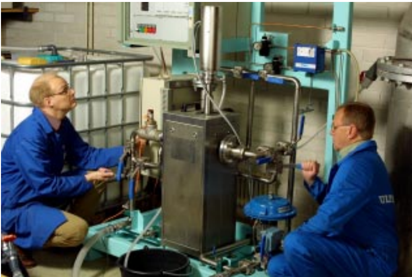
Kuva 2. UÄ-/ UV- koelaitte testauksessa VTT:ssa. Keskellä oleva pystysylinteri on UÄ-lähetin, UV-lamppu on piilossa keskellä sijaitsevan "laatikon takana".
