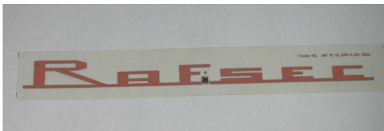
Kuva 8. Rafsec-etätunnistimen siru Philips I.CODE HSL.
