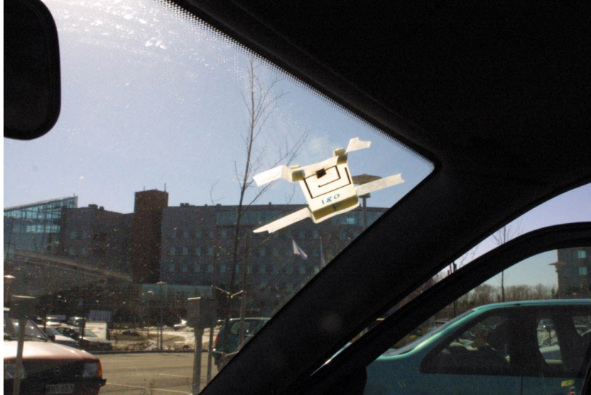
Kuva 14. Etätunnistimen kiinnittäminen tuulilasiin.
