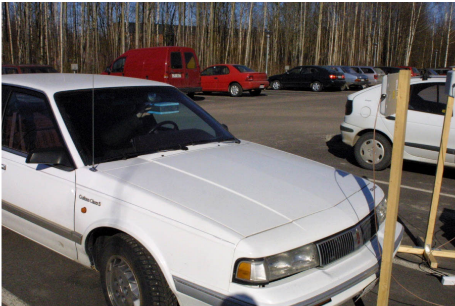
Kuva 13. Tuulilasin vaimennuksen mittaus tavallisella tuulilasilla. Autona Oldsmobile Cutlass Ciera S. Autossa sininen koteloitu etätunnistin.
