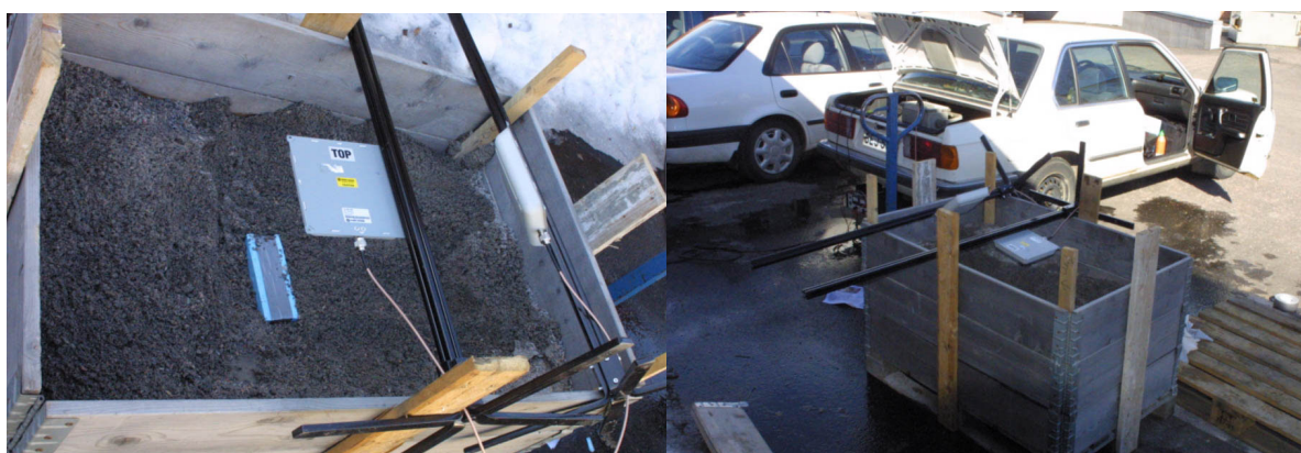
Kuva 18. Mittausjärjestely: Yllä kaavakuva, alla mittalaitteisto ja koteloitu etätunnistin murskeessa.
