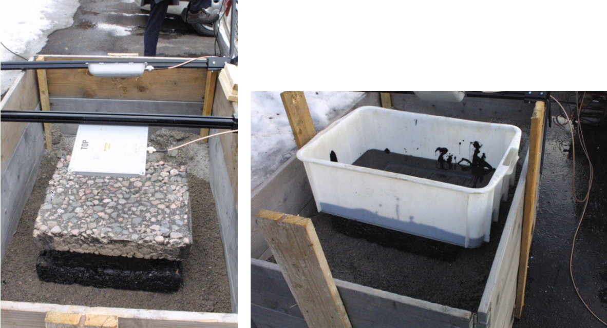
Kuva 19. Vasemmalla mittaus asfalttilaatoilla, oikealla muovilaatikkoon valettu bitumilaatta.
