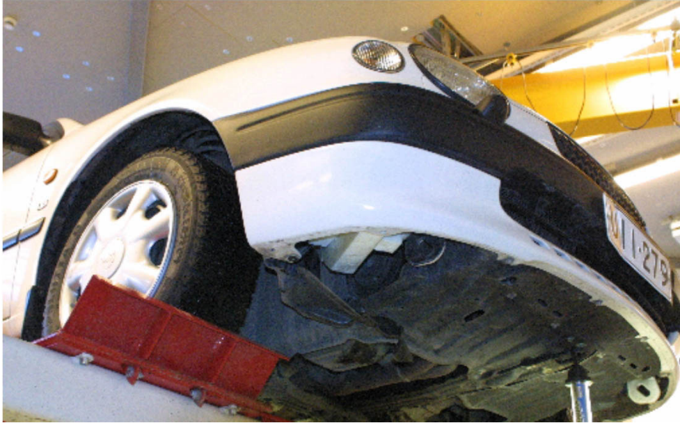
Kuva 2. Etätunniste kiinnitysprofüleineen sijoitettuna autoon.
