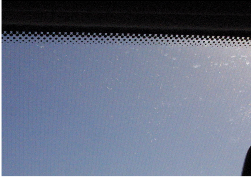
Kuva 16. Ford Mondeon tuulilasin sähkölämmitysvastukset kulkevat pystysuoraan.
