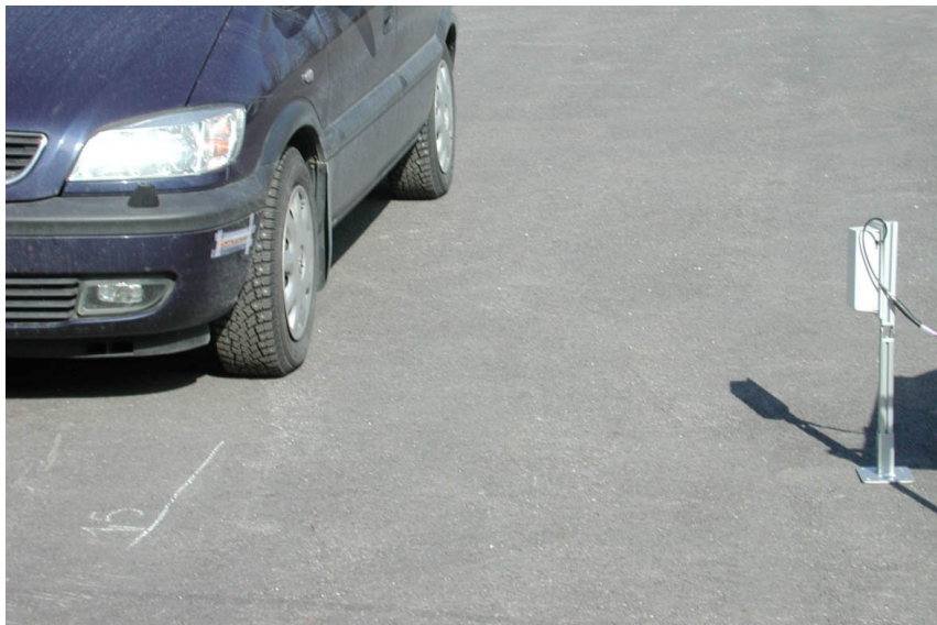
Kuva 11. Mittaustestit VTT-talon parkkipaikalla, etäisyys 1,5 metriä.
