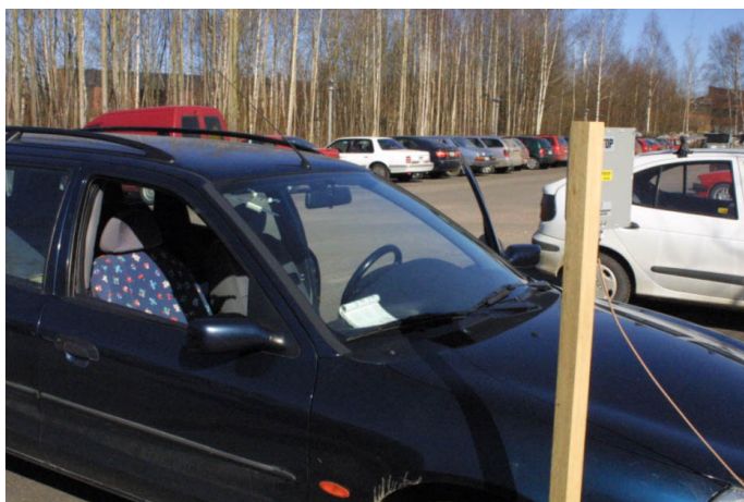
Kuva 15. Tuulilasiin kiinnitetyn etätunnistimen mittaaminen. Yllä geometria ja alla valokuva mittajärjestelystä. Autona on Ford Mondeo, jonka tuulilasi on sähköisesti lämmitetty.
