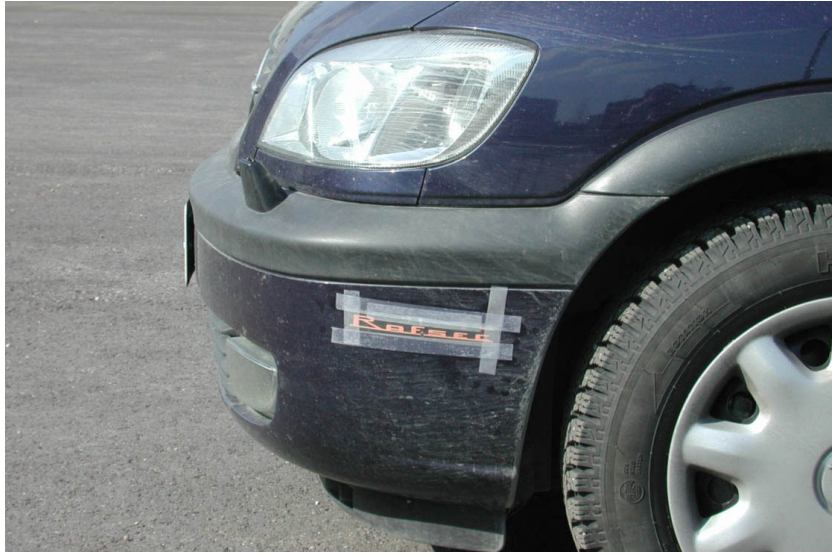
Kuva 10. Etätunnistin kiinnitetty etupuskuriin.
