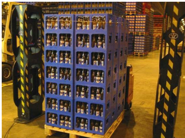
Kuva 8. Useiden korien samanaikainen tunnistaminen on tyypillinen tunnistintörmäysten kannalta haastava tilanne. Kuva Stockwayn pilotoimasta ratkaisusta toukokuulta 2003.
