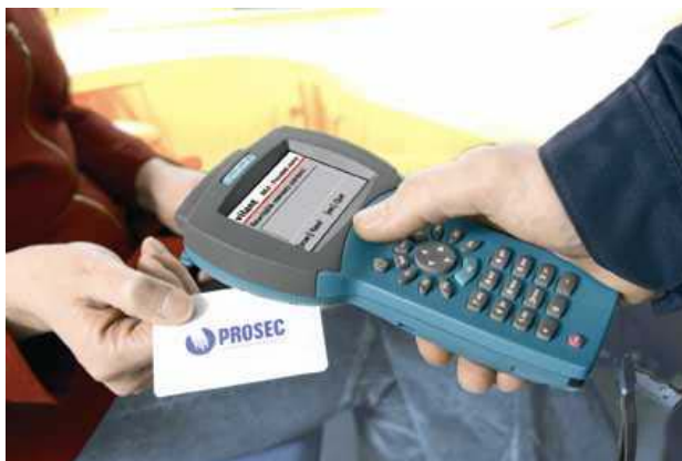
Kuva 6. Käsilukija lukee 13,56 MHz tunnisteeseen muutaman senttimetrin päästä. Kuva: Nordic ID.
