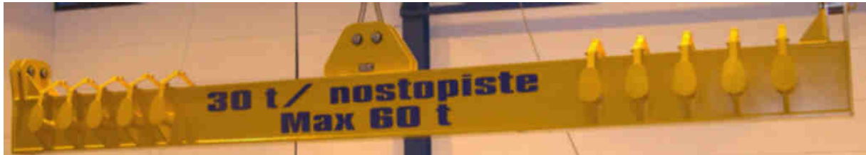
Kuva 5. Esimerkki kuormitusmerkinnöistä nostopalkissa.
