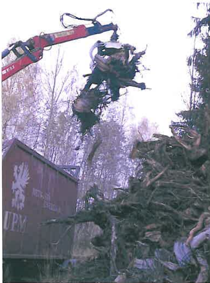
Kuva 7. Kantojen lastaus UPM-Kymmenen työmaalla.
