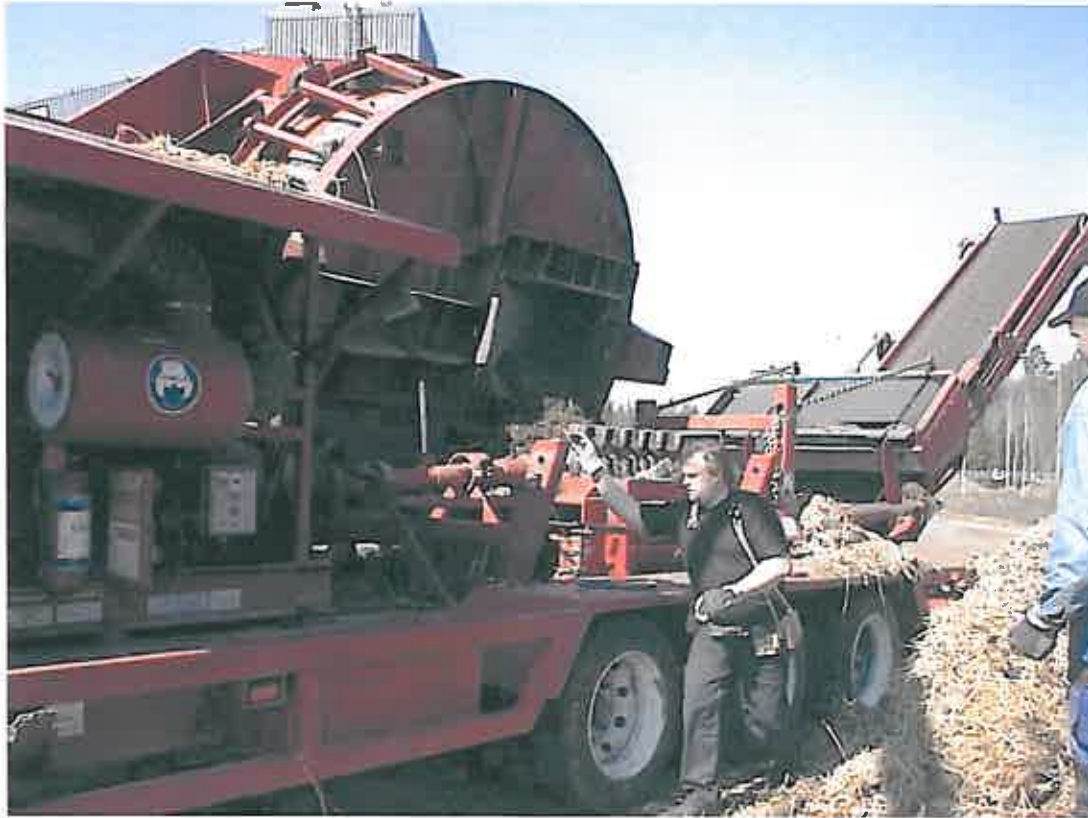
Kuva 9. Murskaimen kuljettaja korjaamassa häiriötilannetta murskaimessa Vaskiluodon Voiman Seinäjoen voimalaitoksella.
