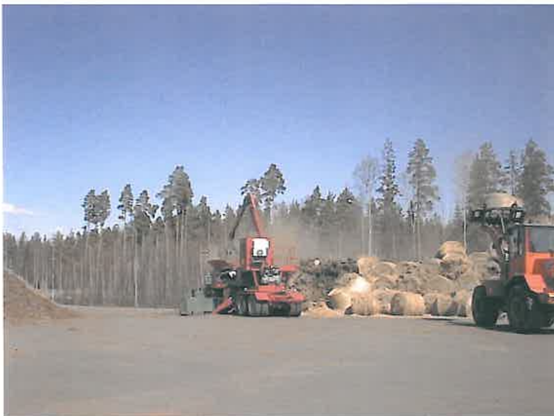
Kuva 3. Ruokohelpipaalien ja kantojen murskausta Vaskiluodon Voiman Seinäjoen voimalaitoksella.
