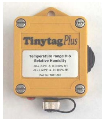
Kuva 4. Ulkoilman olosuhteiden mittauksessa käytetty loggeri (Gemini Data Loggers, 2006).
