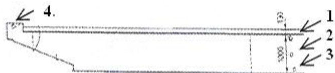
Kuva 6. Antureiden sijainti sillan poikkileikkauksessa.
