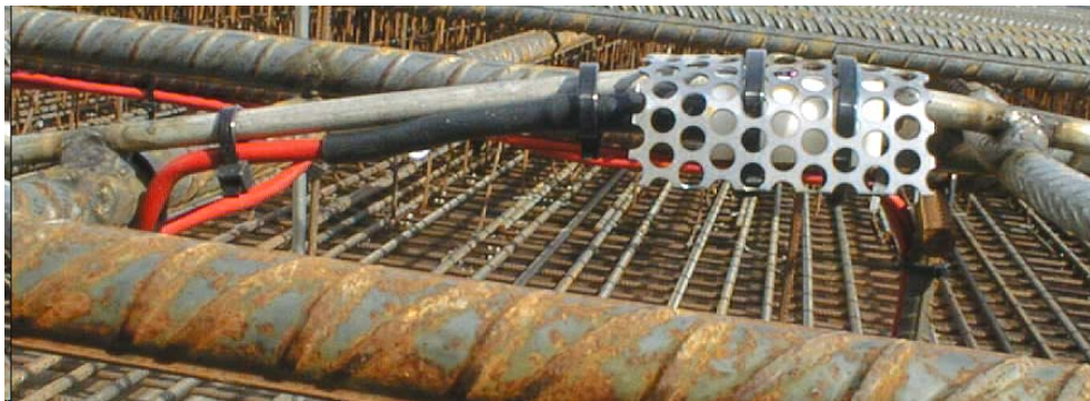
Kuva 1. Betonin sisään valettava MS-sensori metalliverkolla suojattuna (Väyrynen, R. 2000).
