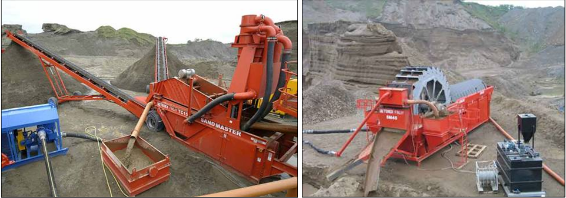
Kuva 9. Vesiseulontayksikkö (vas.) ja poistoveden lietteen erotuskalustoa (lähde: www.terexfinlay.com ).
