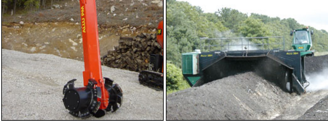
Kuva 11. Stabilointiin tarkoitettu sekoitinyksikkö (vas.) ja aumankääntäjä (lähde: www.allu.net ).
