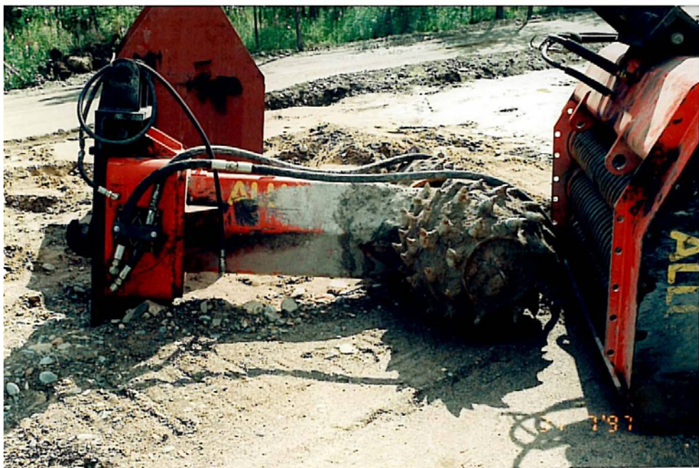
Kuva 5.10. Stabiloinnissa käytetty ”maamyrrä”-sekoitin.
