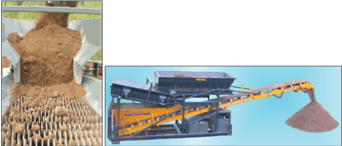
Kuva 5. Esimerkki tähtiseulasta (lähde: www.remu.fi ).
