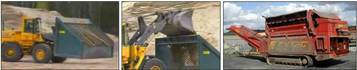
Kuva 1. Siirrettävä välppä (vas. ja kesk., lähde www.vimelco.com ) sekä täryllä ja kuljettimella varustettu tela-alustainen välppäyksikkö.
