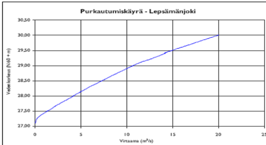
Kuva 12. Lepsämänjoki lm -havaintoasemalle (Nurmijärvellä) muodostettu veden purkautumiskäyrä.
