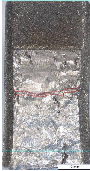
Kuva 53. Koesauva B2. Alloy 52 (TU2), ilmakoe, kuormitusnopeus 0,1 mm/h.
