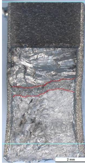
Kuva 58. Koesauva C2. Alloy 182 (TV), ilmakoe, kuormitusnopeus 0,1 mm/h.
