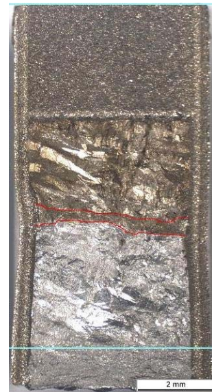
Kuva 62. Koesauva C6. Alloy 182 (TV), koeympäristö 2, kuormitusnopeus 0,1 mm/h.
