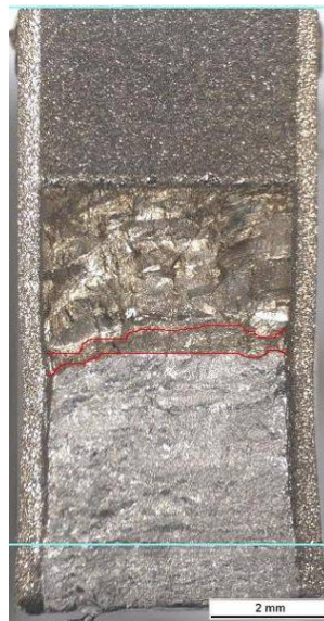
Kuva 61. Koesauva C5. Alloy 182 (TV), koeympäristö 2, kuormitusnopeus 6,7 mm/h.
