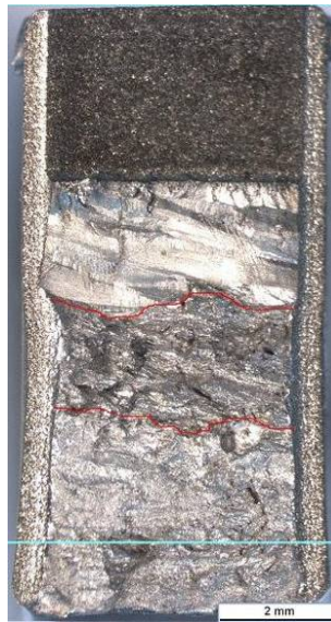
Kuva 66. Koesauva D2. Alloy 182 (NO), ilmakoe, kuormitusnopeus 0,1 mm/h.
