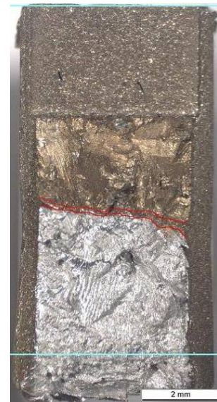
Kuva 56. Koesauva B5. Alloy 52 (TU2), koeym- päristö 2, kuormitusno- peus 0,1 mm/h.
