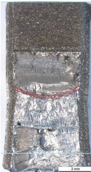
Kuva 54. Koesauva B3. Alloy 52 (TU2), koeym- päristö 1, kuormitusno- peus 0,1 mm/h.
