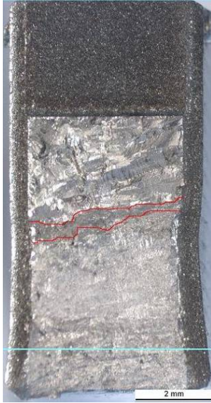
Kuva 57. Koesauva C1. Alloy 182 (TV), ilmakoe, kuormitusnopeus 6,7 mm/h.
