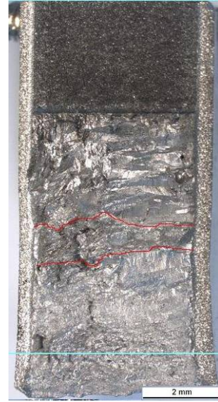
Kuva 59. Koesauva C3. Alloy 182 (TV), koeympäristö 1, kuormitusnopeus 0,1 mm/h.
