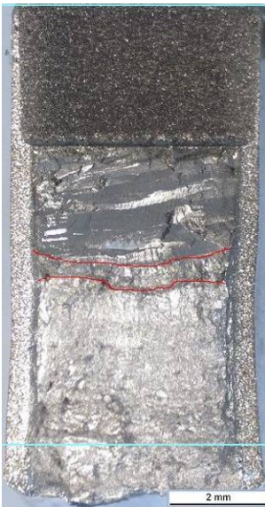
Kuva 60. Koesauva C4. Alloy 182 (TV), koeympäristö 1, kuormitusnopeus 0,1 mm/h.
