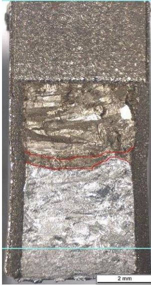
Kuva 63. Koesauva C7. Alloy 182 (TV), koeympäristö 2, kuormitusnopeus 0,1 mm/h.
