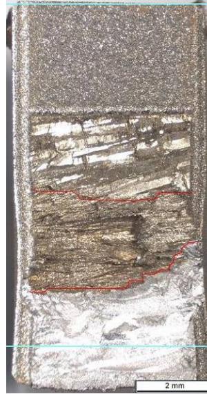
Kuva 68. Koesauva D4. Alloy 182 (NO), ympäristö 3, kuormitusnopeus 0,1 mm/h.
