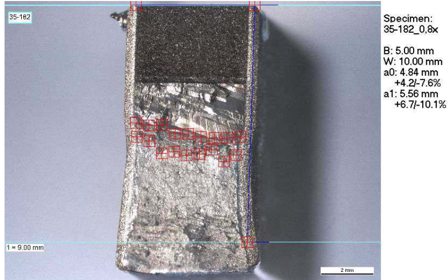
Kuva 38. Särönpituuden määrittäminen Cracklength-ohjelmalla.
