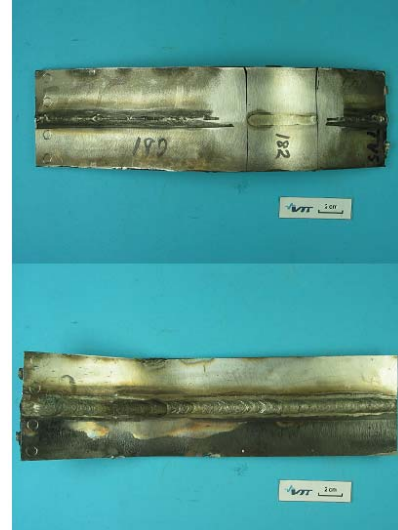
Kuva 29. Näyte TV. Piirros hitsistä sekä kuva hitsatusta kappaleesta ylä- ja alapuolelta.
