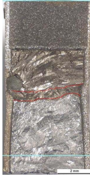
Kuva 64. Koesauva C8. Alloy 182 (TV), koeympäristö 3, kuormitusnopeus 0,1 mm/h.
