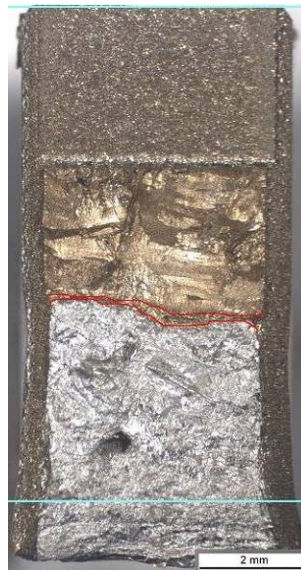
Kuva 55. Koesauva B4. Alloy 52 (TU2), koeym- päristö 2, kuormitusno- peus 6,7 mm/h.
