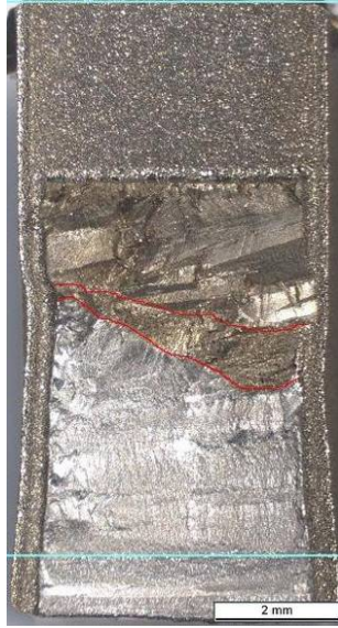
Kuva 67. Koesauva D3. Alloy 182 (NO), ympäristö 3, kuormitusnopeus 6,7 mm/h.
