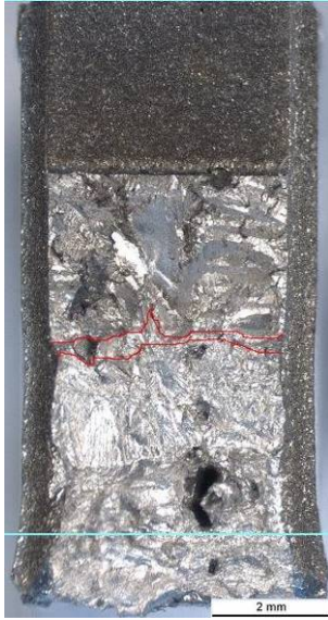
Kuva 52. Koesauva B1. Alloy 52 (TU2), ilmakoe, kuormitusnopeus 6,7 mm/h.
