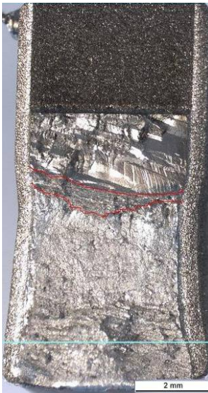
Kuva 65. Koesauva D1. Alloy 182 (NO), ilmakoe, kuormitusnopeus 6,7 mm/h.
