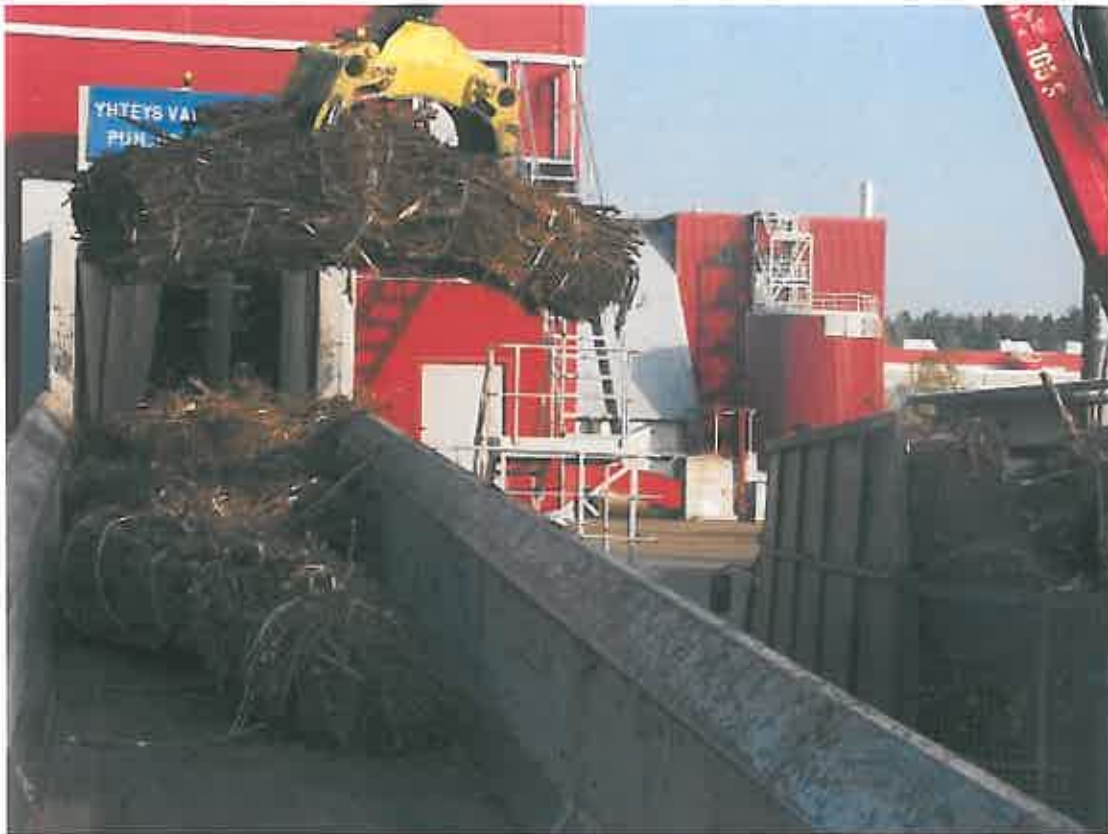
Kuva 7. Risutukkien purku kuorma-autosta kuljettimelle Kaipolassa. Takana näkyy tila, jossa on murskain koteloituna.
