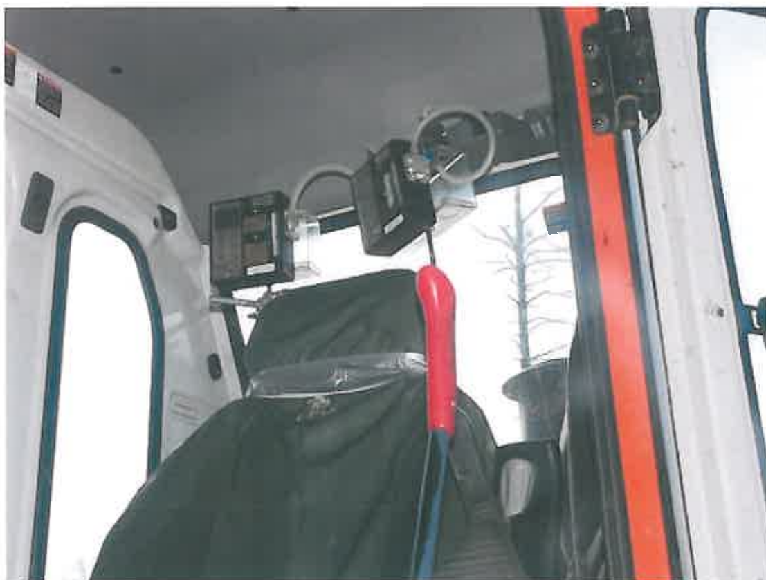
Kuva 8. Mittauslaitteet asennettuna työtilaan
