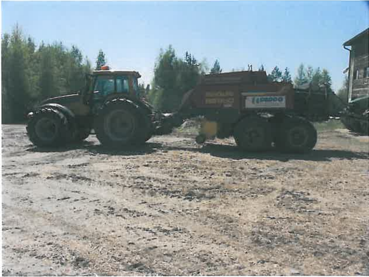
Kuva 2. Ruokohelven kanttipaalain, NewHolland BB960A, vetotraktorina John Deere 7920.
