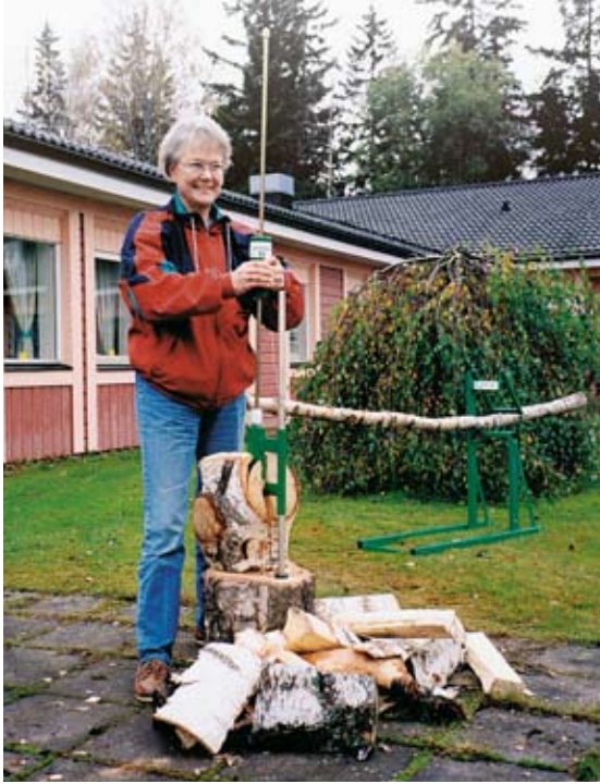
Helppohalkojassa iskuvoima ohjataan halkaisukiilalle hallitusti. Kuva: Smart Splitter
