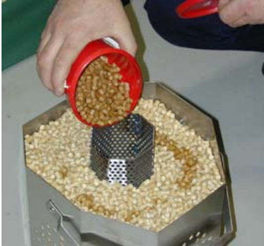
Pellettipoltin sytytetään sytytysnesteellä kostutetuilla pelleteillä (3 dl panos). Kuva: Heikki Oravainen
