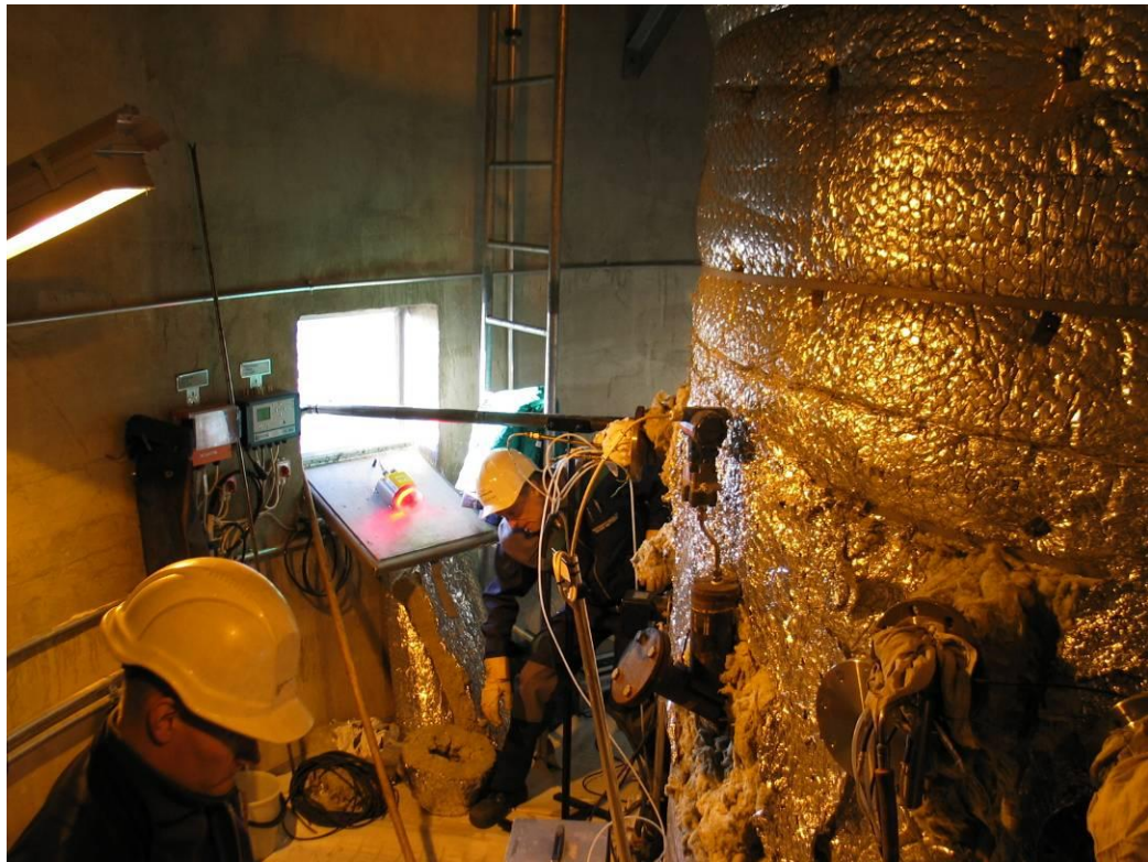
Kuva 8. Lentovalojen huoltoaukon hyödyntäminen päästömittauksissa
