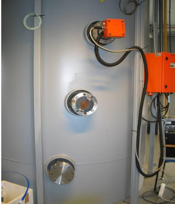
Kuva 7. AMS-mittalaite ja SRM:n mittaussyhteitä
