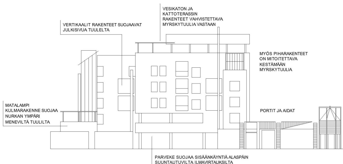
Kuva 29. Rakennuksen muotoilulla ja yksityiskohdilla voidaan vaikuttaa lähiympäristön tuulisuuteen ja vähentää tuulen jäähdyttävää vaikutusta. (Kuismanen 2008)
