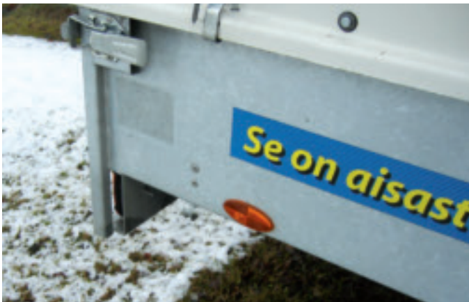
Abb.3: Von VTT entwickelte Sol-Gel Beschichtungen auf einem feuerverzinkten Hänger nach dem Langzeit-Haltbarkeitstest. Ein nicht beschichteter Bereich wurde als Referenzbereich ausgespart. (Photo Tapio Harju, Finnish Galvanizers)
