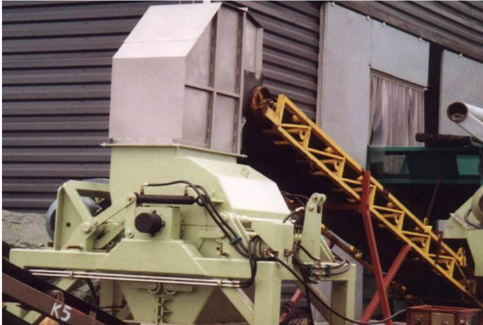
Kuva 1. VTT:n tehokas hienomurskain raaka-aineen hienonnuksen ja esikäsitteilyyn.
