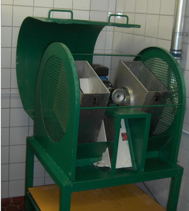
Kuva 6. Pellettien käsittelykestävyyden mittauslaite (CEN/TS 15210-1 mod.).
