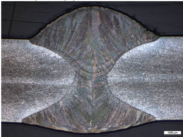
304-TR-M-4.0 Perusaine: 1.4301 C850 Lisäaine: \varnothing 1,0 mm 308LSi Arvot: 3,3 kJ/cm, 0,65 m/min
