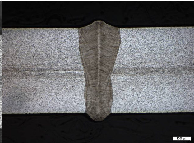
301-LB Perusaine: 1.4318 C850 Lisäaineeton laserhitsi Arvot: 3 kW
