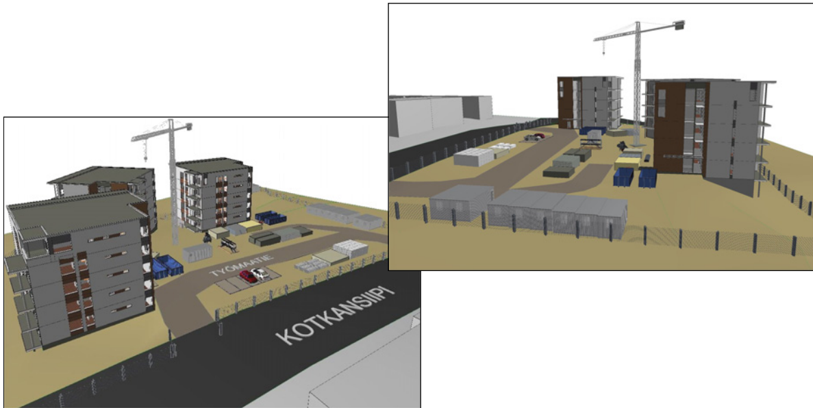
Kuva 11 Näkymiä TurvaBIM-hankkeessa mallinnettuun työmaan tietomallipohjaiseen aluesuunnitelmaan.
