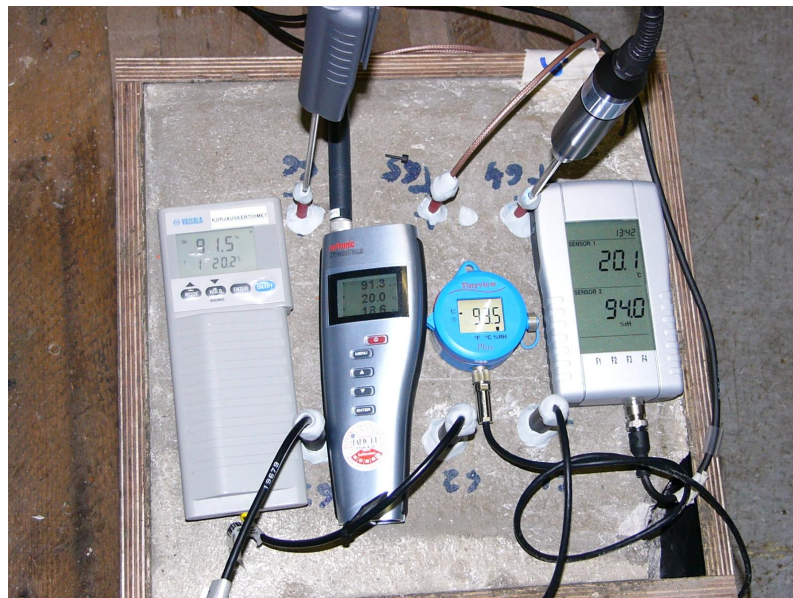
Kuva 7. Betonin suhteellisen kosteuden mittaus betoniin poratusta reiästä
