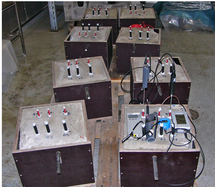
Kuva 5. Tutkimuksessa käytetyt betonilaatat säilytettiin vakioilmastohuoneissa.
