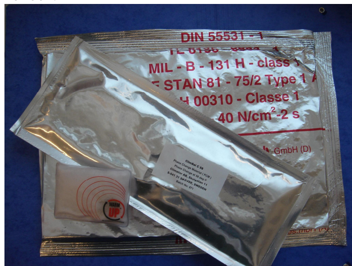
Kuva 4.1.1. Kaupallisia PE/alumiinifolioon pakattuja faasimuutossuoloja.
