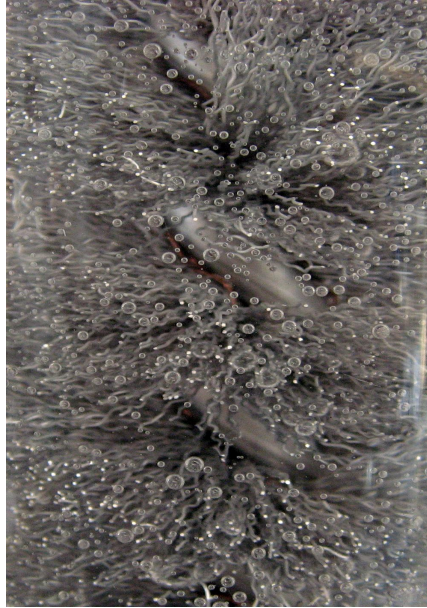
Kuva 5.4.6. Lämmönvaihdin pinoille nestemäiseen SAT:iin syntyviä kaasukuplia.
