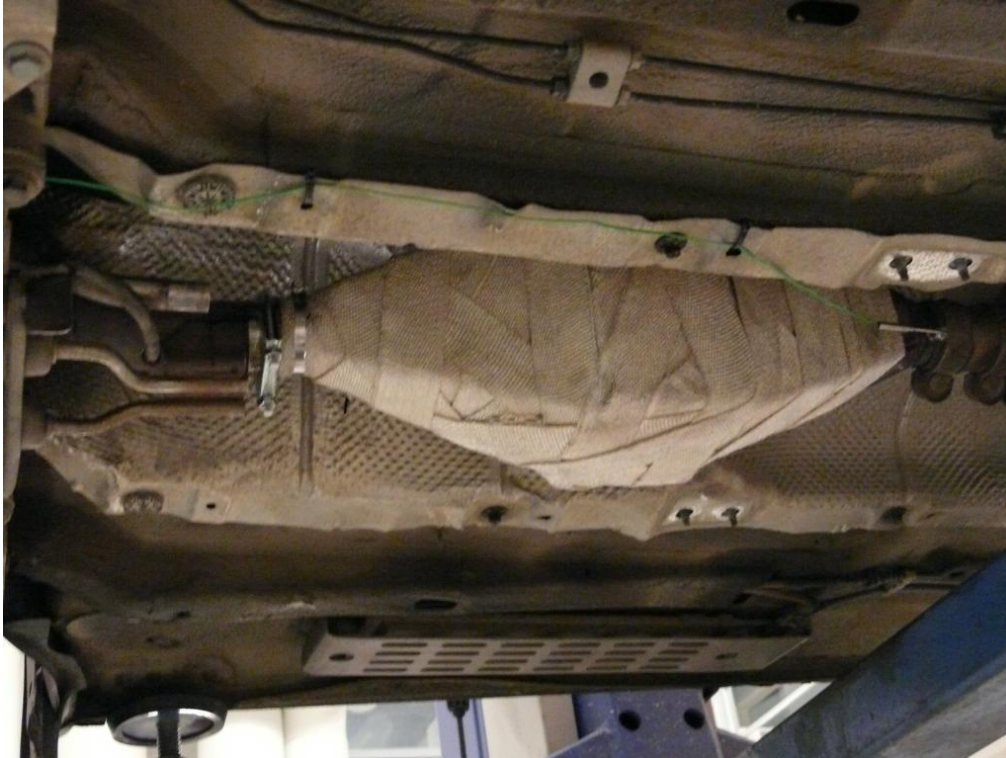
Kuva 4.4.4. Pakokaasulämmönvaihdin auton alustassa.
