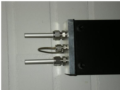
Kuva 4.3.2. Vasemmalla pakastekuljetukseen kehitetyn kylmävaraajapalkin pää, jossa näkyy kaksi jäähdytysputkea ja lämpötila-anturin pää. Oikealla koko palkit.
