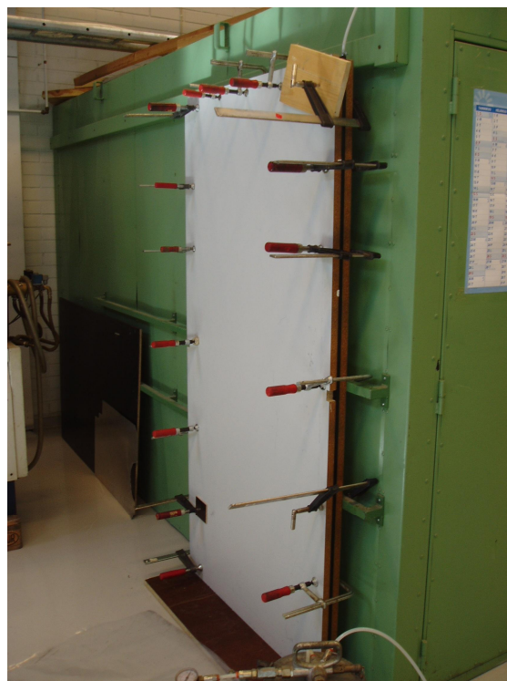
Kuva 4.3.1. Alumiini-hunajakennolevyn täyttö faasimuutosparafiinilla.
