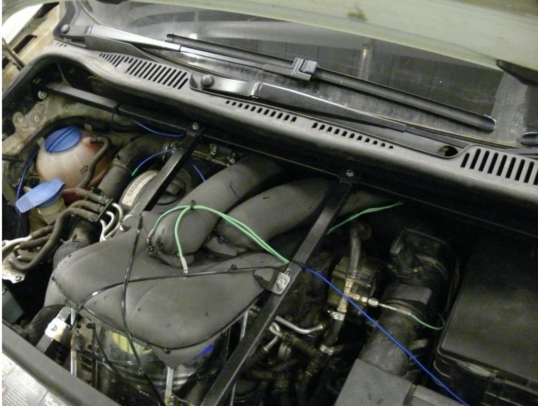
Kuva 4.8.1. Lämpöakku asennettuna VW Caddyn moottoritilaan.
