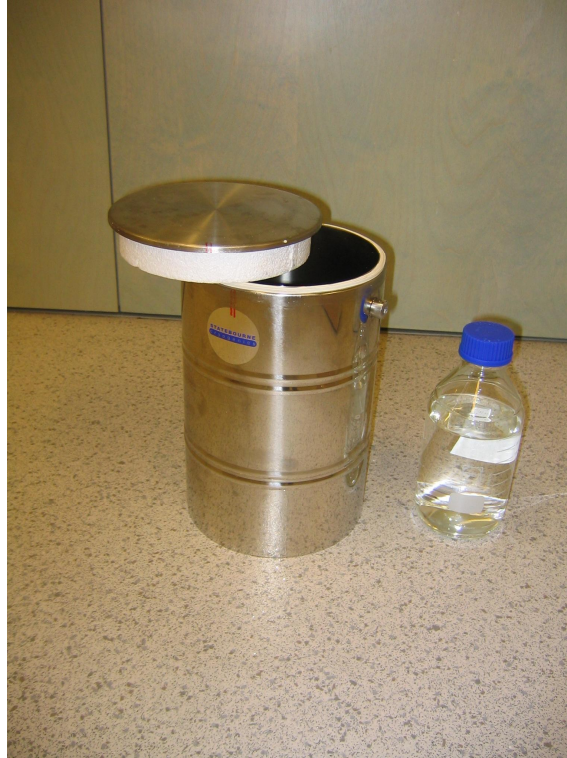
Kuva 4.3.3. Lämpöakussa käytetty 6 dm 3 nestetyppiastia.
