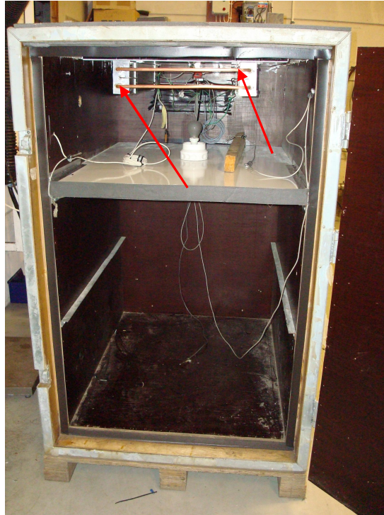
Kuva 4.5.2. Pakastekuljetuspalkit (punaiset nuolet) Lumikko Oy:n toisessa testilaatikossa.
