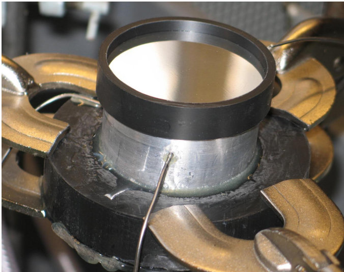
Kuva 4.6.2. a) Vasemmalla eristämätön jäähdytystanko-moduuli ja b) oikealla vastaava jäähdytyskiekko-moduuli. Tutkittava näytteet asetettiin kuvassa kirkkaana näkyvälle metallipinnalle.
