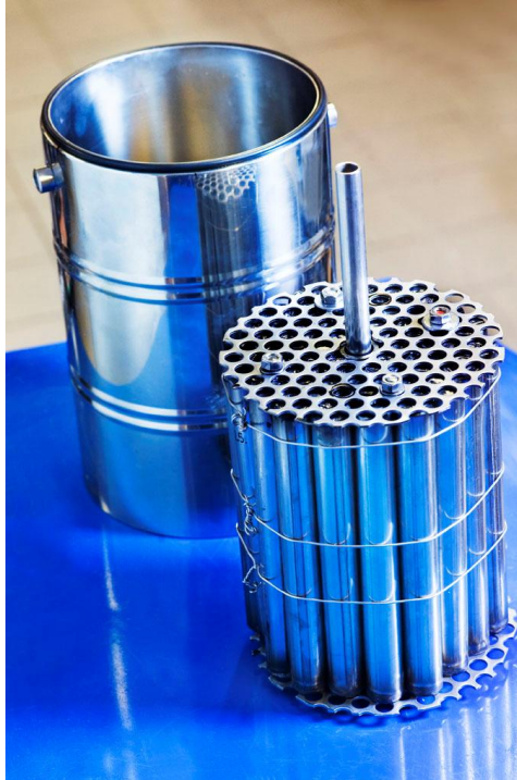
Kuva 4.3.5. Toisen sukupolven lämpöakun nestetyppiastia ja PCM -patteristo.
