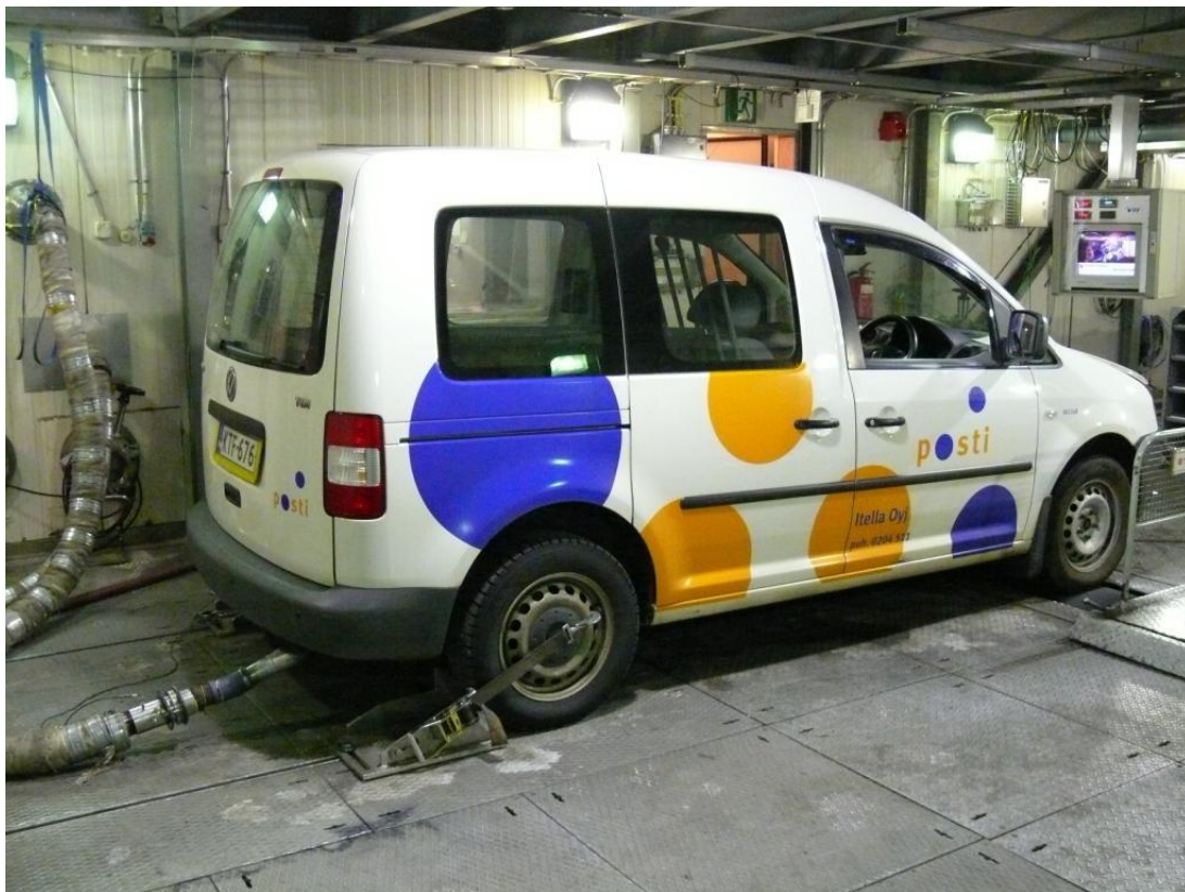
Kuva 4.8.2. Itella Oyj:n VW Caddy VTT:n alustadynamometrillä.
