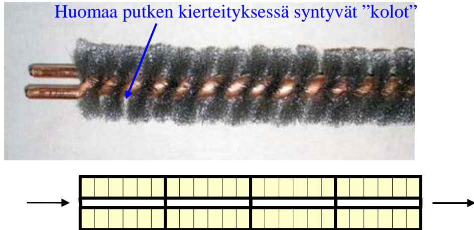
Kuva 4.7.2. Harjalämmönsiirtimen jako osiin vesivirtauksen suunnassa harjalämmönsiirtimessä.
