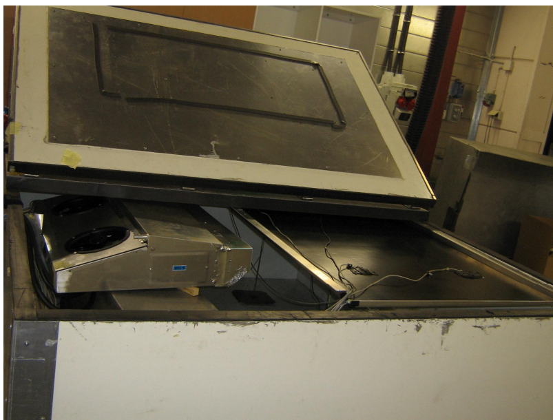
Kuva 4.5.1. Viileäkuljetuskylmäakku Lumikko Oy:n testilaatikossa. Vasemmalla on kylmäkoneen höyrystin ja oikealla kylmäakkulevy.
