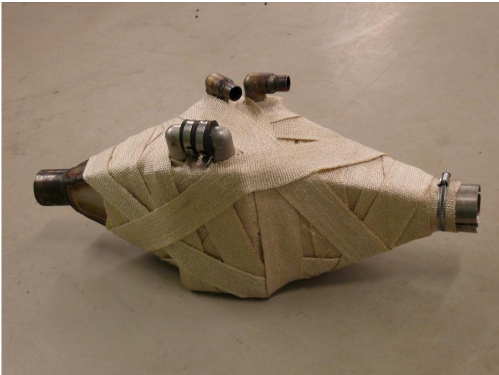
Kuva 4.4.3. Kennojen kotelo kennot sisään suljettuina ja eristettynä, letkuliittimineen.
