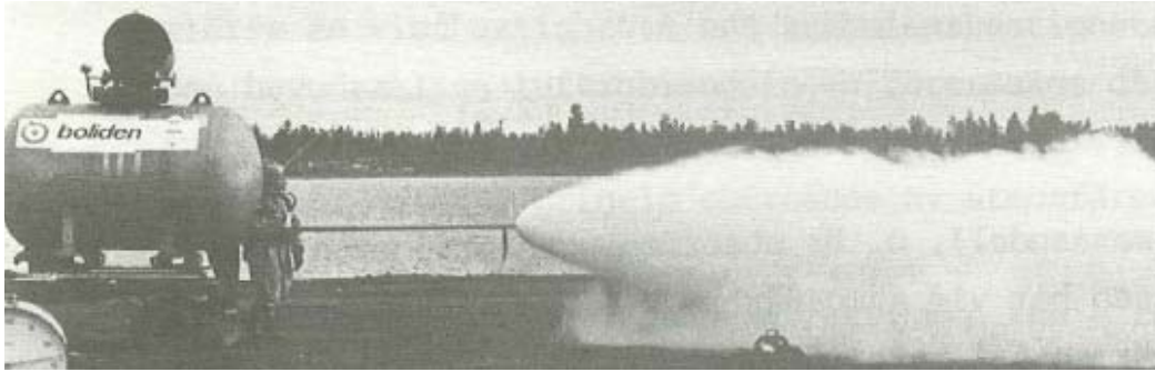
Kuva 4. Rikkidioksidin purkausputken päähän muodostui sumusuihku (Nyrén & Winter 1986).
