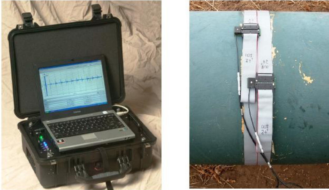
Kuva 7. MsS laitteisto, tietokone ja mittauslaite vasemmalla. Oikealla mittauspanta, joka koostuu kahdesta putkeen kiinnytetyistä magnetostriktiivisestä nauhasta sekä parista lattakaapelista niiden päällä (GWA brochure).
