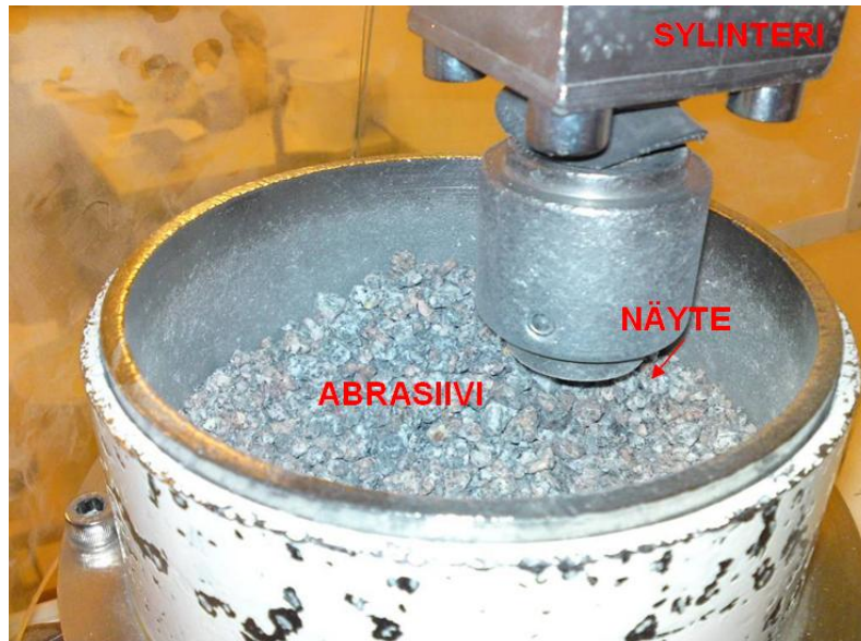
Kuva 12. Murskaavan pin-on-disk abraasiokulutuslaitteiston osia. Näytetapin kulutettavan tasaisen pinnan pinta-ala on 1000 mm 2 ja näytetapin korkeus on 35 mm. Alustalevyn halkaisija on 160 mm. Abrasiivia rajoittavan seinän sisähalkaisija on 150 mm.
