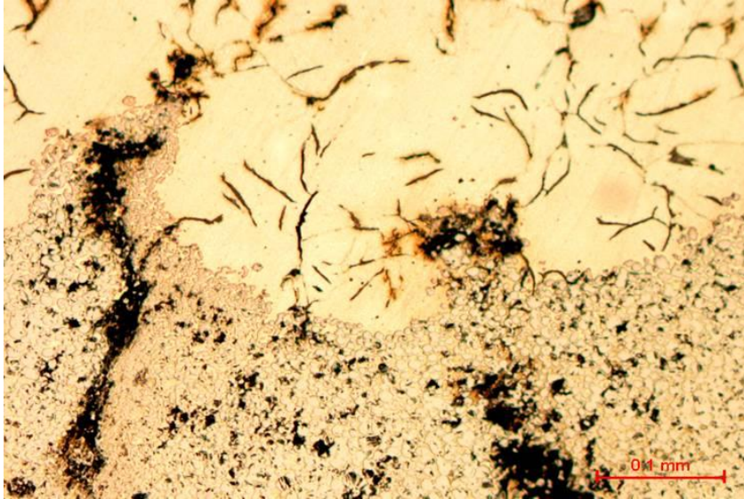
Kuva 5. Onnistunut GJL/SHS-laattaliitosvalu 15.12.2009 eri suurennoksilla. SHS-laatta 1671g1- 25%Ni- AISI316 TIG-hitsattu.
