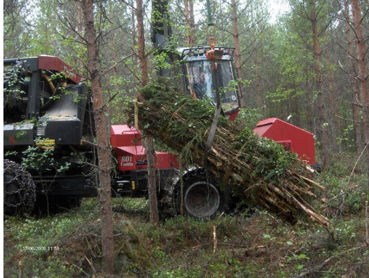
Kuva 1. Fixterillä valmistetun paalin punnitus 17.6.2009. Kuva: Ari Erkkilä
