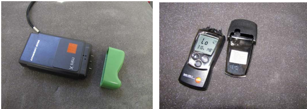
Kuva 35. WSAB Lignomat Mini X – kosteusmittari (vasemmalla) ja Testo 606-2 – kosteusmittari (oikealla). Kuvat: Antti Heikkinen
