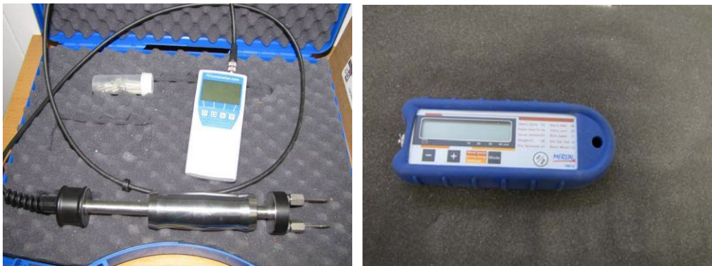
Kuva 36. Humimeter BLW– kosteusmittari (vasemmalla) ja Merlin PM 1-E– kosteusmittari (oikealla). Kuvat: Antti Heikkinen
