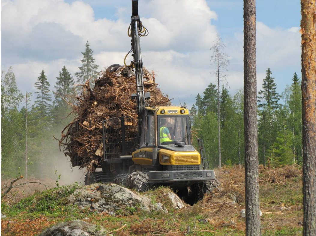
Kuva 18. Toivakassa kuljetettiin kannot tienvarteen Ponsse Elephant -ajokoneella, jossa oli kuormatilan pohjalle asennettu putkimatot. Kuva: Jyrki Raitila
