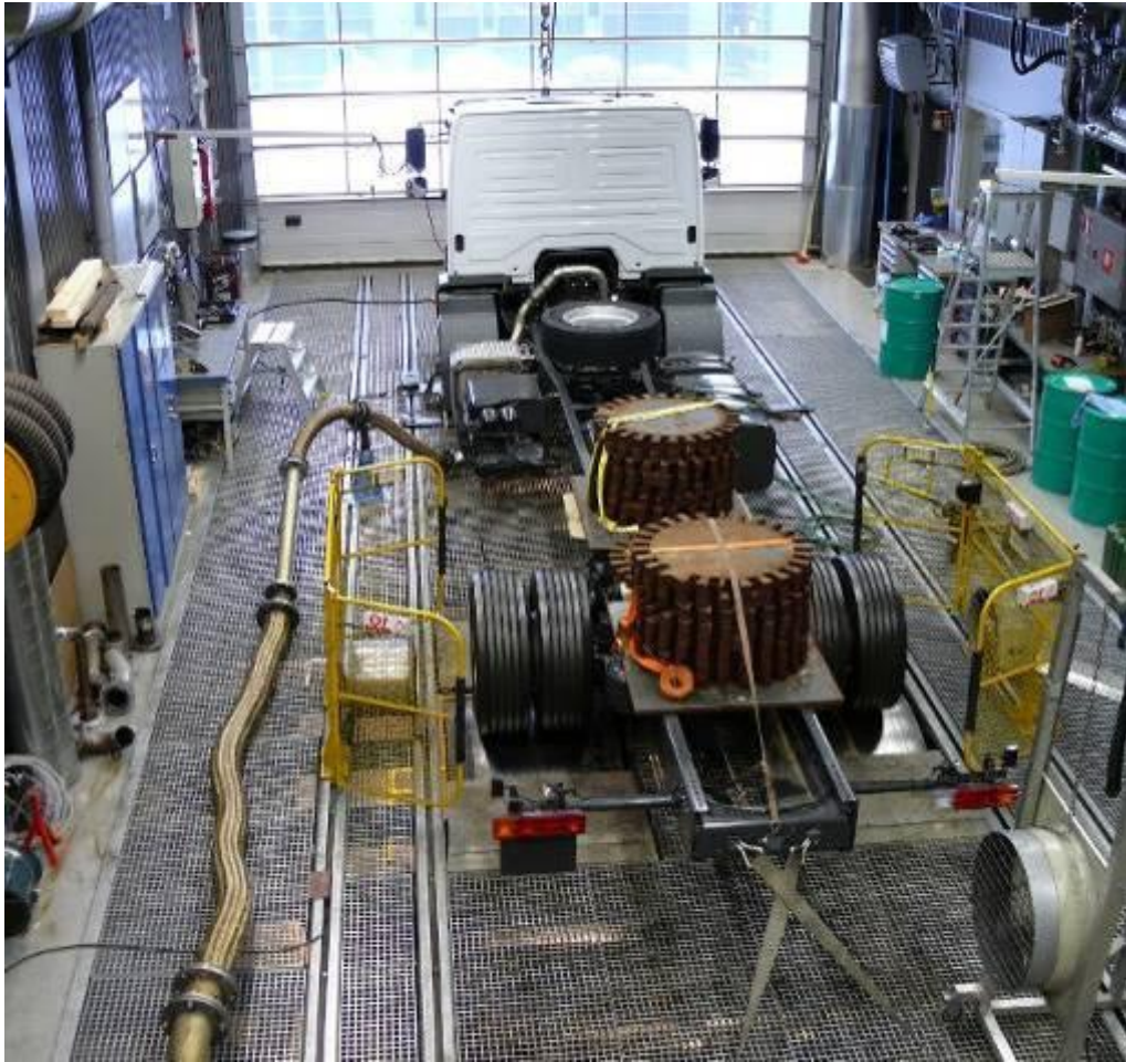
Kuva 5.8 Mercedes-Benz kuorma-auto mittauksissa alustadynamometrillä. Ajoneuvon rungon päälle lastattu painoja riittävän pidon takaamiseksi.
