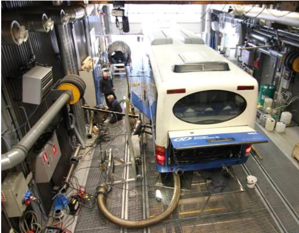
Kuva 5.3 VTT:n alustadynamometrillä on tutkittu lukuisilla eri puhdistinjärjestelmällä varustettuja linja-autoja.
