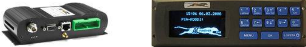
Kuva 5.20. Ajoneuvotietokone ja sen käyttöliittymä.
