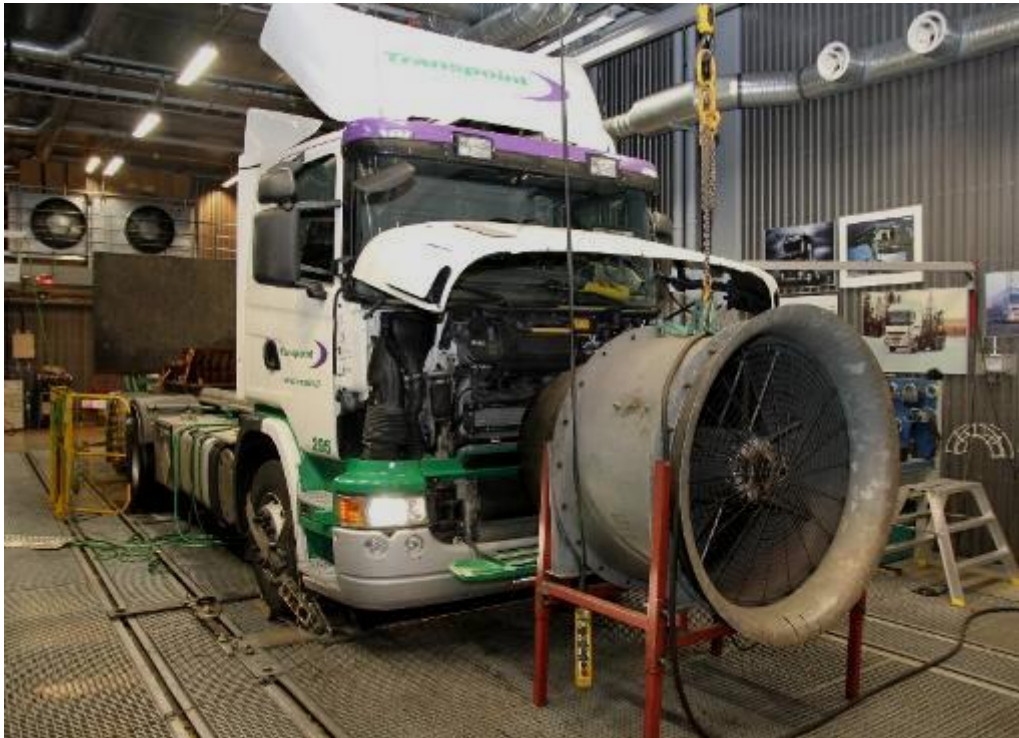
Kuva 5.7 Scanian yhdistelmän vetoauto seurantamittauksissa. Auton edessä laboratoriolaitteisiin kuuluva jäähdytyspuhallin.
