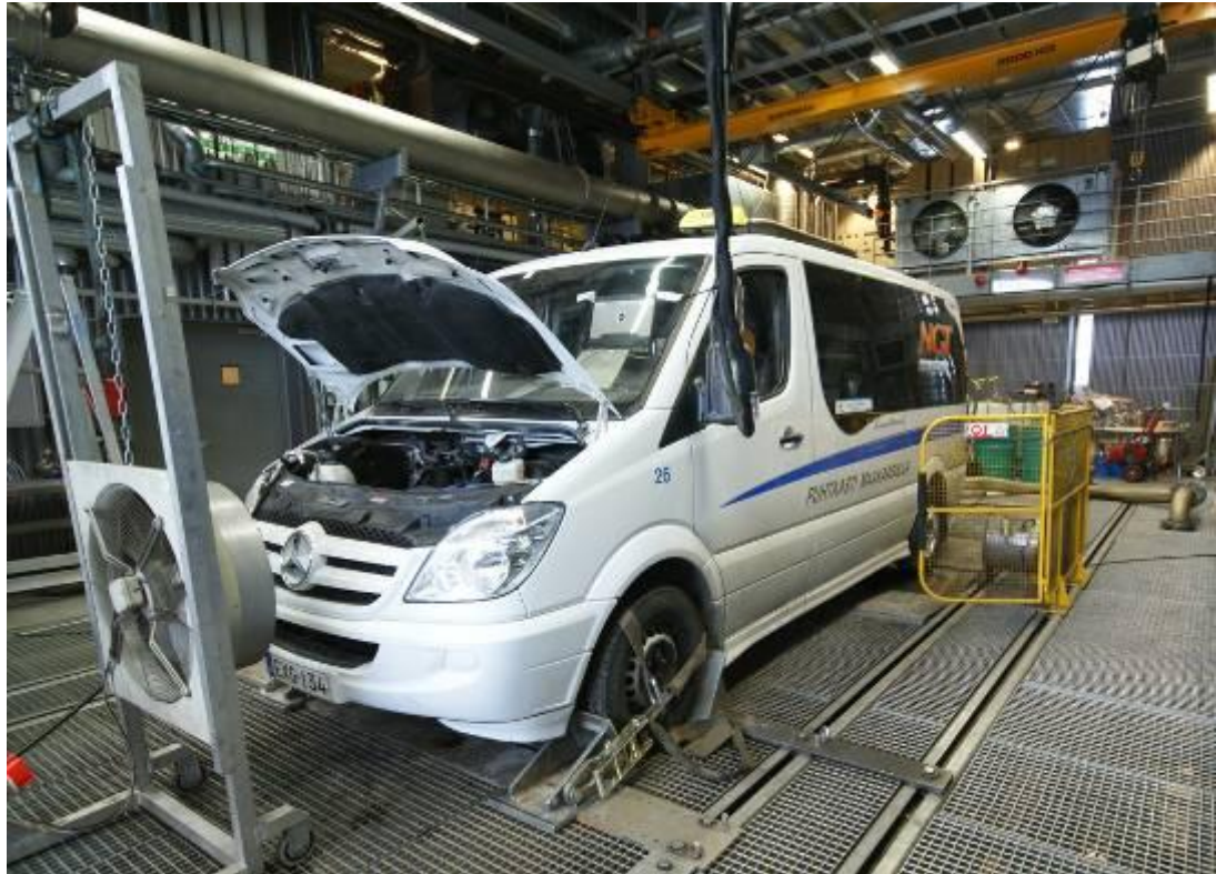
Kuva 5.6 Kaasumoottorilla varustettu Mercedes-Benz Sprinter mittauksissa alustadynamometrillä.
