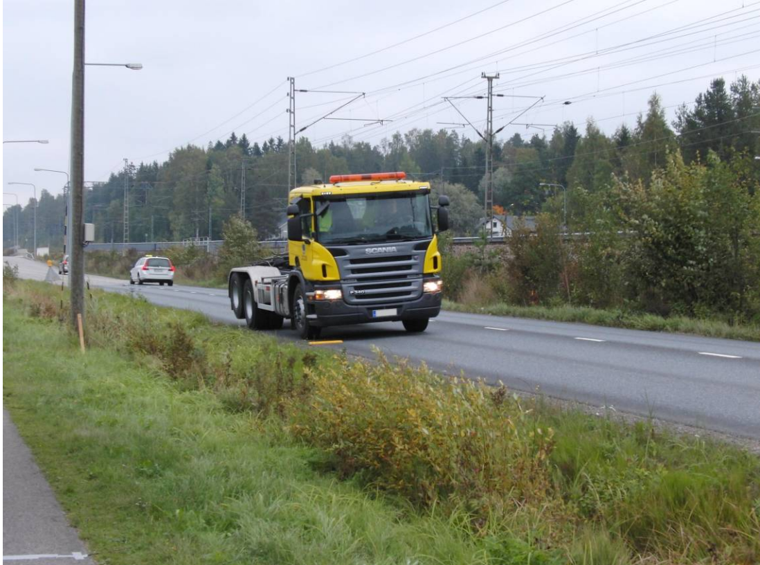
Kuva 8. Tärinälähteenä käytetty kuorma-auto ylittämässä töyssyä.
