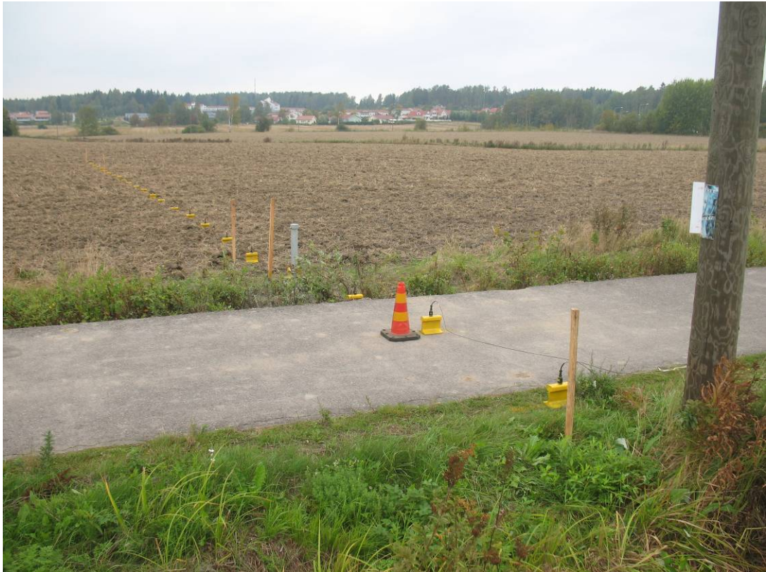
Kuva 6. Mittauslinja A kohtisuoraan tiehen nähden. Anturit on sijoitettu 2 m välein.
