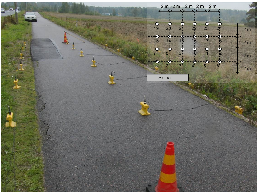
Kuva 7. Mittausalue B tärinäesteen päässä. Anturit on sijoitettu 2 m x 2 m ruudukkoon.
