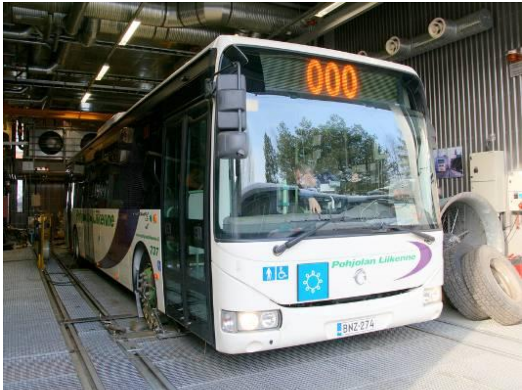
Kuva 20: Kaupunkibussi mittauksissa alustadynamometrilla (Iveco Crossway SCRT)
