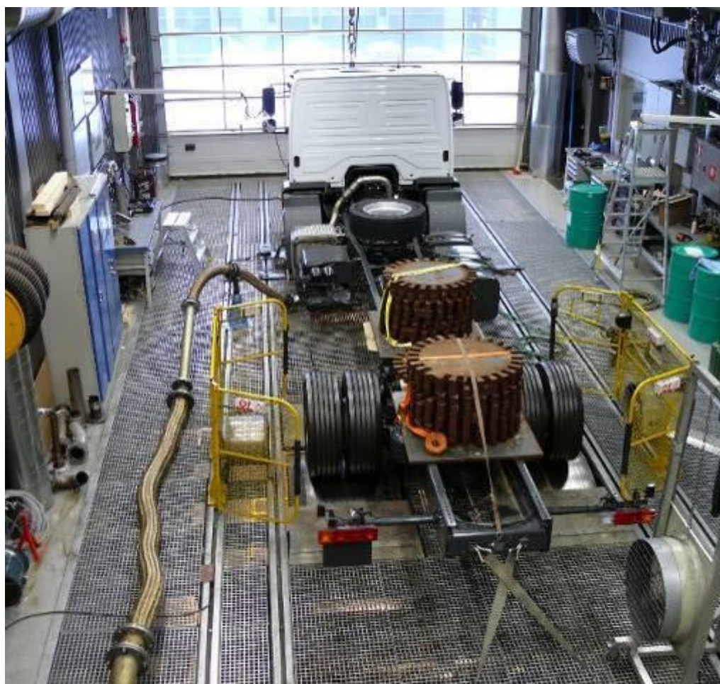
Kuva 24: Mercedes-Benz kuorma-auto mittauksissa alustadynamometrillä. Ajoneuvon rungon päälle lastattu painoja riittävän pidon takaamiseksi
