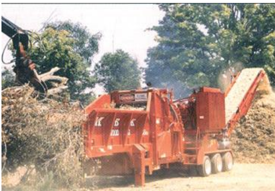
Kuva 9. Raskaat mobiilmurskaimet soveltuvat paremmin tasaisille asfalttipäällysteisille terminaaleille kuin tienvarsimurskaukseen.
