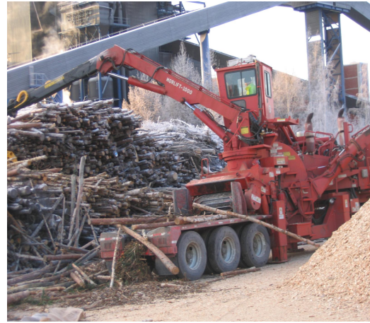
Kuva 8. Terminaaleilla voidaan käyttää samoja mobiilihakkureita kuin tienvarsihaketuksessa ja laitosalueella toimiessa.
