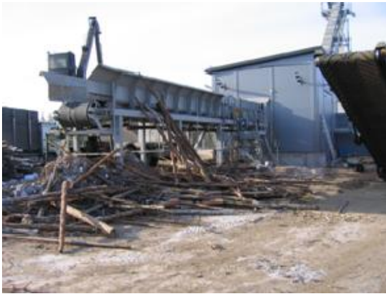
Kuva 10. Vasemmalla Rovaniemen terminaalin kiinteän hakeaseman ranka- ja kokopuulle soveltuva syöttöpöytä. Oikealla Pihtiputaan terminaalissa käytössä oleva kiinteä sähkökäyttöinen kaksivaihemurskain.
