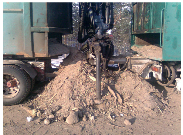
Kuva 15. Vasemmalla tasoseulalla kantomurskeesta poistettua karkeaa kivi- ja puuainesta. Oikealla; kantoauton pohjalta laitoksilla kuorman purkupaikalle voi pahimmissa tapauksissa kertyä suuret määrät polttoon kelpaamatonta hieno- ja kiviainesta.
