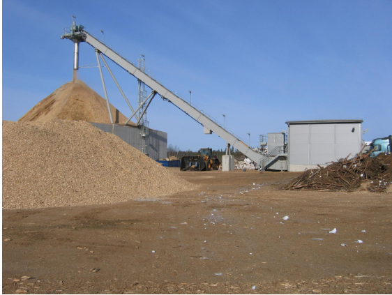
Kuva 2. Esimerkit sekä kiinteän suuren haketusaseman (Rovaniemen Mustikkamaa) että siirrettävän hakkurin (Pihtipudas) vaatimista tilantarpeista terminaali-alueella.
