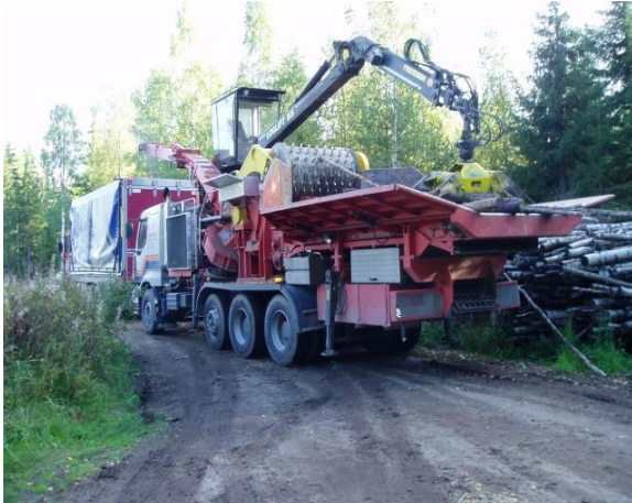
Kuva 8. Terminaaleilla voidaan käyttää samoja mobiilihakkureita kuin tienvarsihaketuksessa ja laitosalueella toimiessa.
