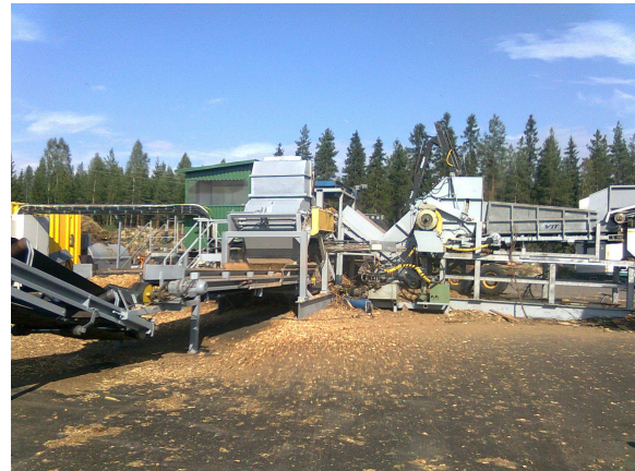
Kuva 10. Vasemmalla Rovaniemen terminaalin kiinteän hakeaseman ranka- ja kokopuulle soveltuva syöttöpöytä. Oikealla Pihtiputaan terminaalissa käytössä oleva kiinteä sähkökäyttöinen kaksivaihemurskain.
