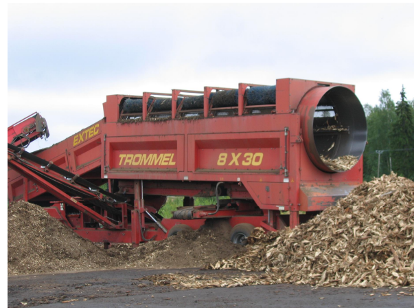
Kuva 14. Epäpuhtauksien poistoa kantomurskeesta on testattu sekä monivaiheisella tasoseulalla että pyörivällä rumpuseulalla.
