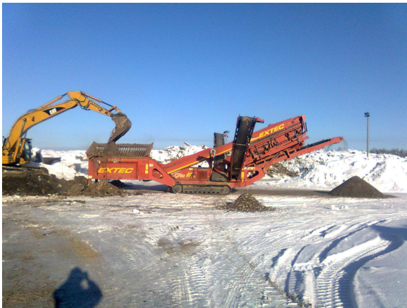
Kuva 14. Epäpuhtauksien poistoa kantomurskeesta on testattu sekä monivaiheisella tasoseulalla että pyörivällä rumpuseulalla.
