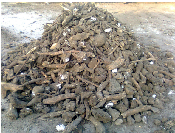
Kuva 15. Vasemmalla tasoseulalla kantomurskeesta poistettua karkeaa kivi- ja puuainesta. Oikealla; kantoauton pohjalta laitoksilla kuorman purkupaikalle voi pahimmissa tapauksissa kertyä suuret määrät polttoon kelpaamatonta hieno- ja kiviainesta.
