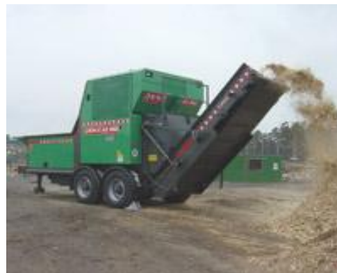
Kuva 9. Raskaat mobiilmurskaimet soveltuvat paremmin tasaisille asfalttipäällysteisille terminaaleille kuin tienvarsimurskaukseen.
