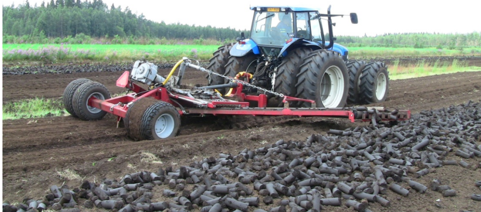
Kuva 2. Monikerroskuivausmenetelmässä palat asetetaan kuivausalustalle kuljettimen avulla. Kuivausalustalla ei liikuta eikä paloja käännetä (kuva A. Erkkilä).
