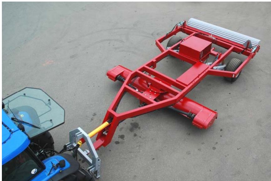
Kuva 1. Monitoimivaunu MTV-2010 tuotantosarkojen muotoiluun ja tiivistämiseen (kuva SampoTech Oy).
