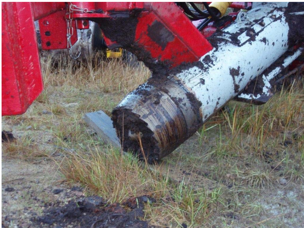
Kuva 4. Marraskuun alussa 2011 suoritettiin onnistunut koeajo uudentyypisellä turpeen syöttölaitteella. Laite mahdollistaa myös pintapalan tuottamisen mataloituneilta kentiltä (kuva O. Patokoski).
