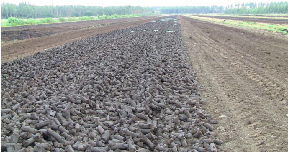
Kuva 3. Tuotantokauden aikana nostetaan useita satokiertoja palaturveta päällekkäin samalle kuivausalustalle. Näin satokierrot eli palakerrokset kuivuvat omaan tahtiinsa sääolojen mukaan (kuva A. Erkkilä).
