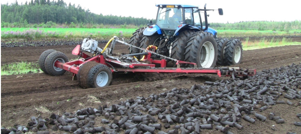
Kuva 4. Monikerroskuivausmenetelmässä palat asetetaan kuivausalustalle kuljettimen avulla. Kuivausalustalla ei liikuta eikä paloja käännetä (kuva A. Erkkilä).
