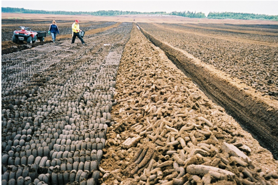
Kuva 3. Karhekuivausmenetelmässä kuivataan kahta satoa samaan aikaan – toista kentällä ja toista karheella (kuva A. Erkkilä).
