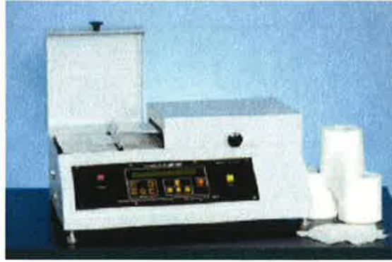
Kuva 17 Pehmopaperien, non-wovenien ja tekstiilien pehmeuden mittaamiseen käytettävä Handle-O-meter-laite. Laite määrittää näytteen pinnan kitkan ja voiman joka tarvitaan näytteen pakottamiseen tietyn levyisen raon läpi. Laitteen valmistaja on Thwing-Albert Instrument Co.
