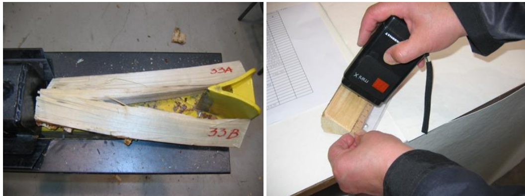
Kuva 60. Kosteuden määrittämistä varten näytepilkkeet halkaistaan ja kosteus mitataan piikkimittarilla halkaistulta pinnalta viiden senttimetrin etäisyydeltä pilkkeen päistä ja puolivälistä.
