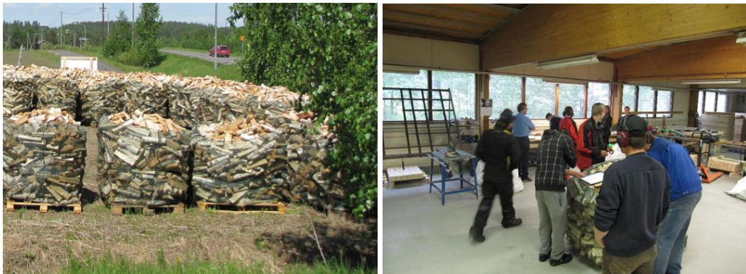
Kuva 26. Pilkkeitä kuivumassa 1,5 irtokuution verkkosäkeissä kuormalavoilla avoimella paikalla kesällä 2010. Yhden säkillisen pilkkeet tutkittiin yksin kappalein.
