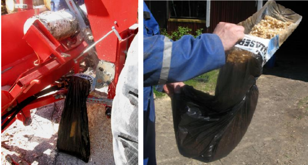
Kuva 16. Muovipussista ja -kanisterista valmistettu purunkerääjä Pilkemasterissa ja purunäytteen pussitus.
