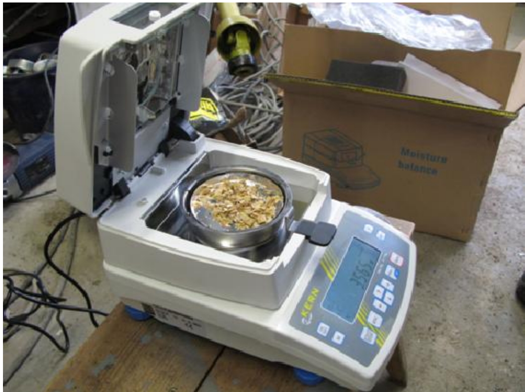
Kuva 18. Purunäyte Kern MLB 50-3N –kosteusmittausvaa’alla.
