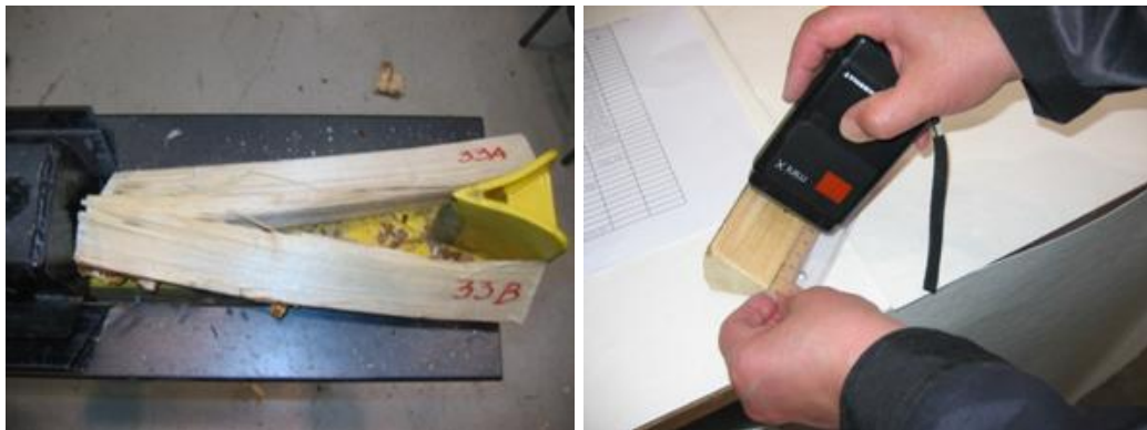
Kuva 67. Näytepilkkeen halkaiseminen ja kosteuden mittaaminen piikkimittarilla halkaistulta pinnalta.
