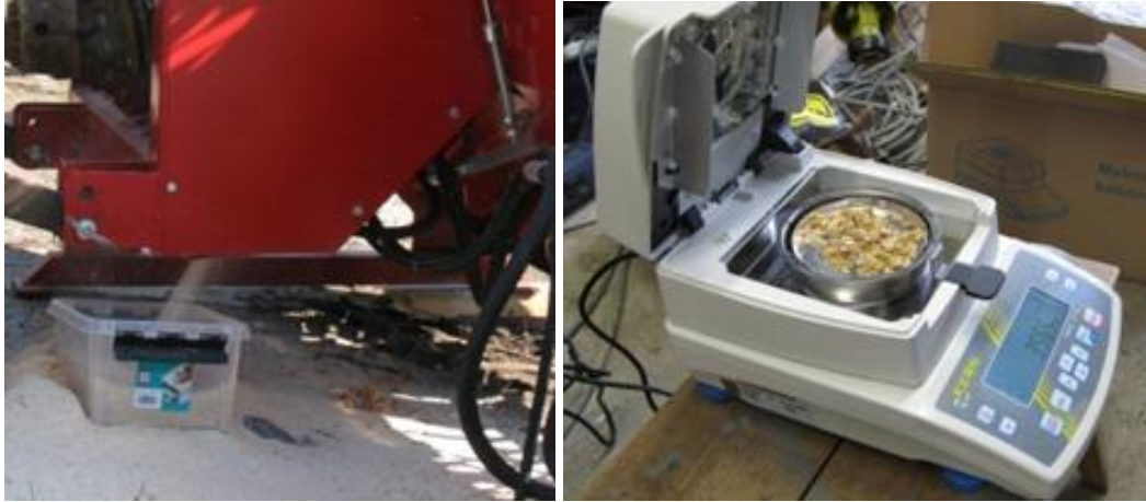
Kuva 65. Puru kerätään kannelliseen muoviastiaan, säilytetään suljettuna ja auringolta suojattuna. Kosteus analysoidaan kosteusmittausvaa'alla.
