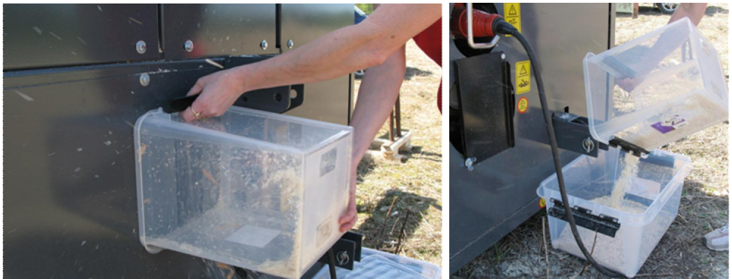
Kuva 17. Purunäytteen kerääminen Palax-pilkekoneesta ja kokoaminen suljettavaan astiaan.
