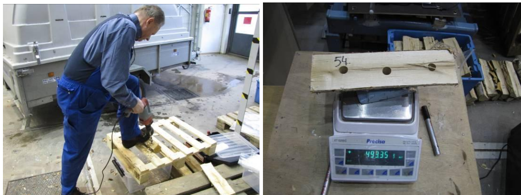
Kuva 62. Kosteusnäytteen ottaminen kuivista pilkkeistä porakoneen ja puuporanterän avulla. Porauslastujen kosteus oli 16,0 % ja pilkkeiden todellinen keskiarvo 19,1 %. Lastut kerättiin 20 pilkkeestä, kolme porausta kuhunkin pilkkeeseen.
