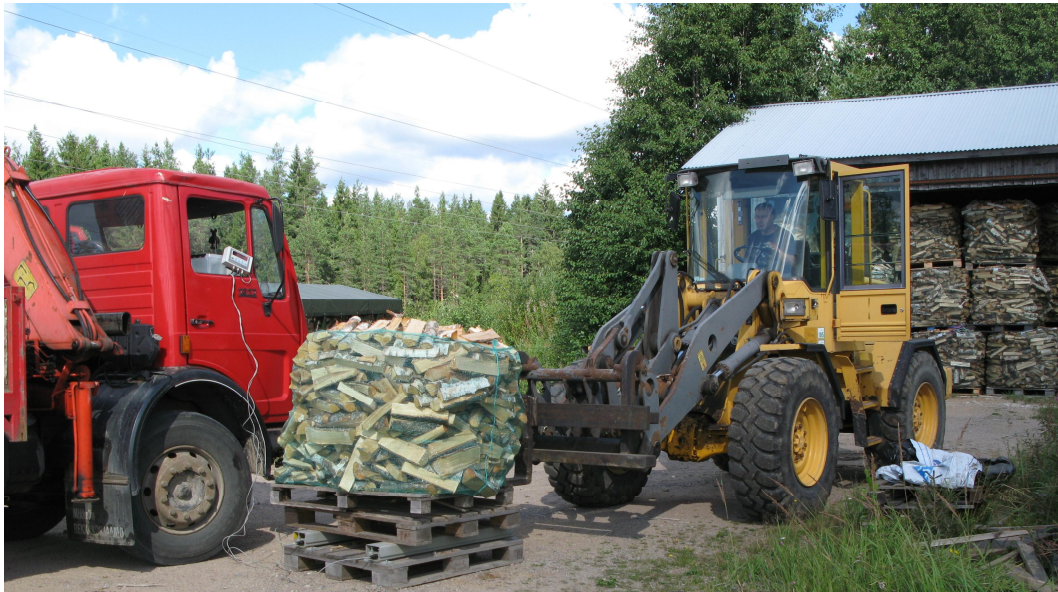
Kuva 23. Pilkelavojen punnitus toimituksen yhteydessä palkkivaa'ojen avulla.
