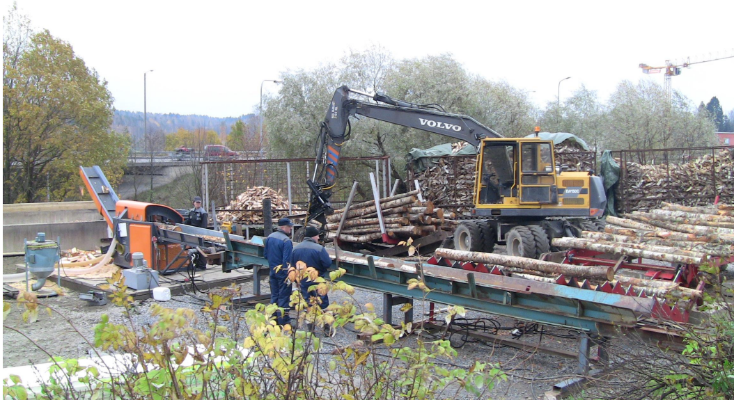
Kuva 10. Pilkonta-asemassa on ketjupöytä, erottelija, syöttökuljetin sekä Sami Autochopper –automaattipilkoja. Pilkkeet putoavat laakasiiloon, josta ne siirretään kuivaushäkkeihin.
