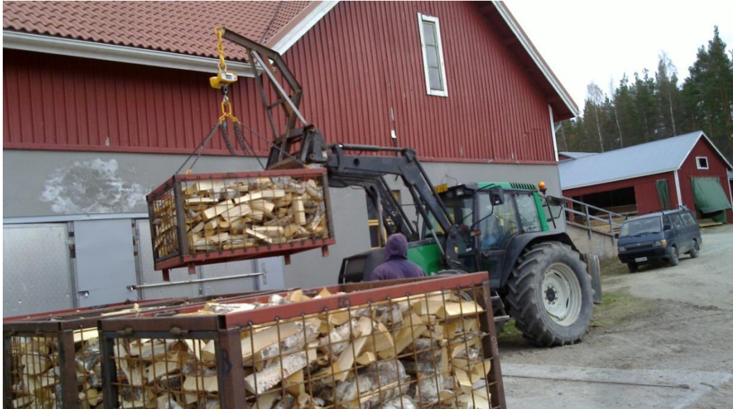
Kuva 12. Pilkkeet valmistetaan häkkeihin, jotka pinotaan päällekkäin ja kuivataan lämminilmakuivurissa.
