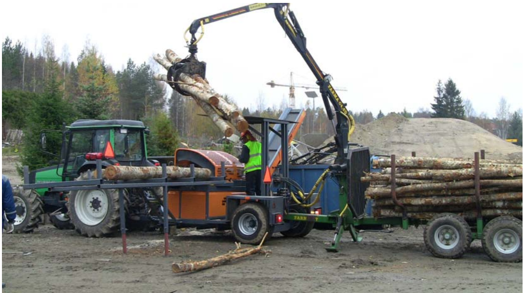
Kuva 2. Ismo Tiihosen suunnittelema ja rakentama siirrettävä pilkonta-asema. Yläkuvassa runkojen nouto pilkontapaikalle. Alakuvassa pilkonta käynnissä. Pilkonta-aseman koneet: traktori Valtra 700, kuormain-metsäperävaunu Farma CT 4,6 – 7D, Sami Autochopper E65-TEC380 -pilkekone, jossa oli 6-osainen halkaisuterä.
