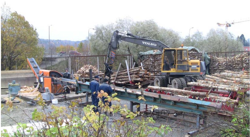
Kuva 4. Ulla Kylmälahden toteuttama siirrettävä pilkonta-asema. Yläkuvassa runkojen nouto pilkontapaikalle. Alakuvassa pilkonta käynnissä. Pilkonta-aseman koneet: Volvo EW150C pyörälustainen kaivinkone ja perävaunu, ketjupöytä,
