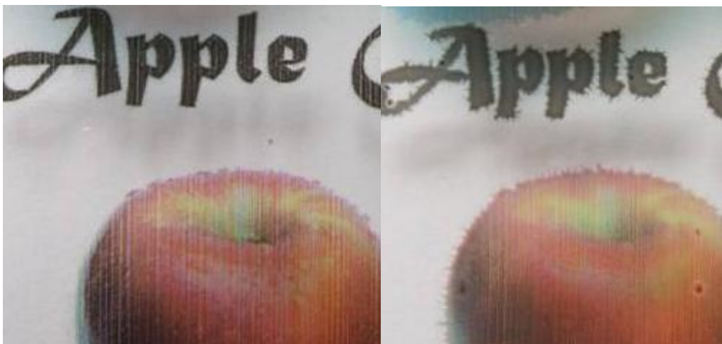
Kuva 10. PET-materiaalilla tulostusjälki oli raidallista sekä pinninglamppujen kanssa (vas.) että ilman (oik.). Ilman pinningkuivausta yksityiskohtien toistokyky oli heikko
