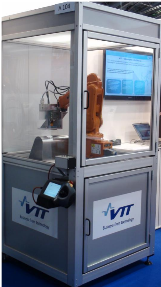
Kuva 2. Suorakuviointin käytännön toteutus, kuvassa yksivärikuviointiin soveltuva ratkaisu.
