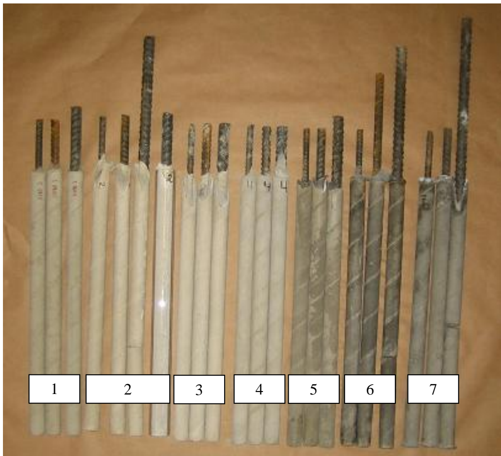
Kuva 2. Betoniterästankojen ´ankkuroinnit´ pahviputkien poistamisen jälkeen (yläpuoliset pinnat). Laastin n:o 2 osalta myös akryyliputkeen ankkuroitu betoniterästanko.
