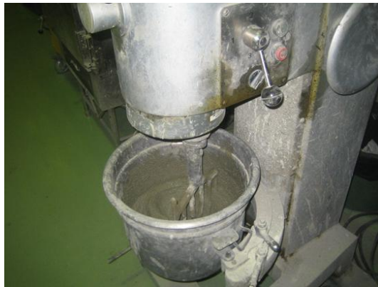
Kuva 1. Laastit sekoitettiin käyttäen sekoitinta Hobart. Annoskoko oli noin 5 litraa (10,4 kg kuivatuotetta + valittu vesimäärä).
