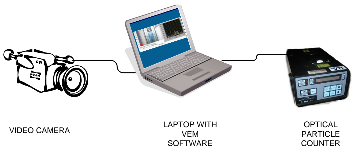
Kuva 6.6 Hiukkaspitoisuuden videopohjainen mittausjärjestelmä.
