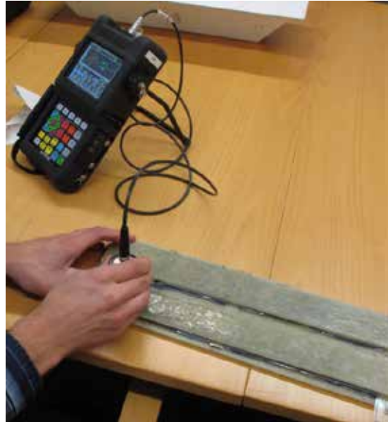
Kuva 27. Liimatun lasikuitu-polyesterikoekappaleen ultraäänitarkastus.
