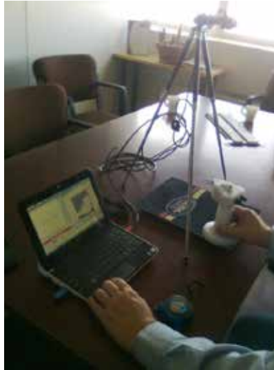
Kuva 28. Liimatun koelaminaatin tarkastus Evisive-mikroaaltolaitteella.
