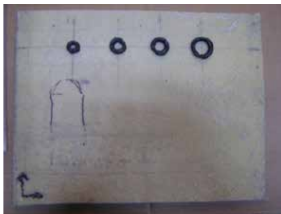
Kuva 4. Vaurioiden tekeminen tiivistysnauhan avulla (koekappale 1).
