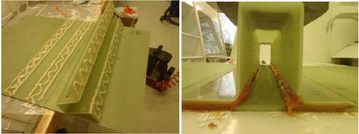
Kuva 63. Sikafast levitys siksak-kuviolla ja muodostunut liimasauma palkin sisällä.
