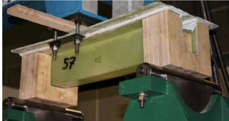
Kuva 69. Kolmipistetaivutuskokeissa käytetty koejärjestely.
