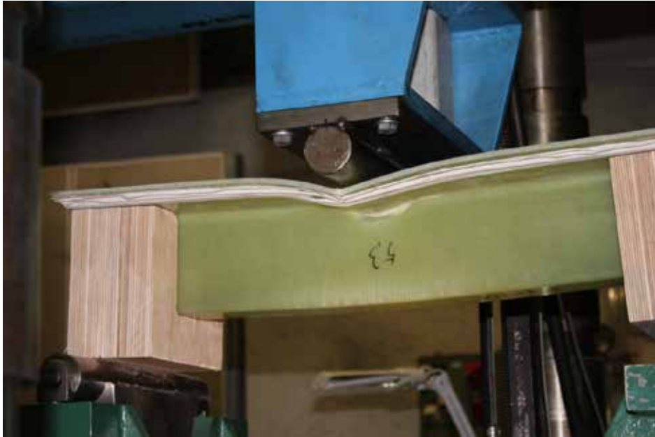
Kuva 71. Koekappaleen 66 murtuma painimen kohdalta leikkautumalla.
