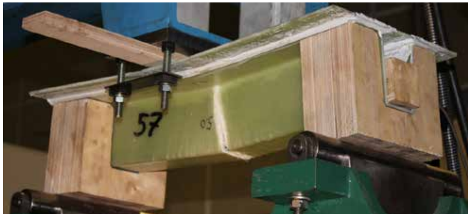
Kuva 70. Tyypillinen vauriomuoto staattisessa kolmipistetaivutuksessa.
