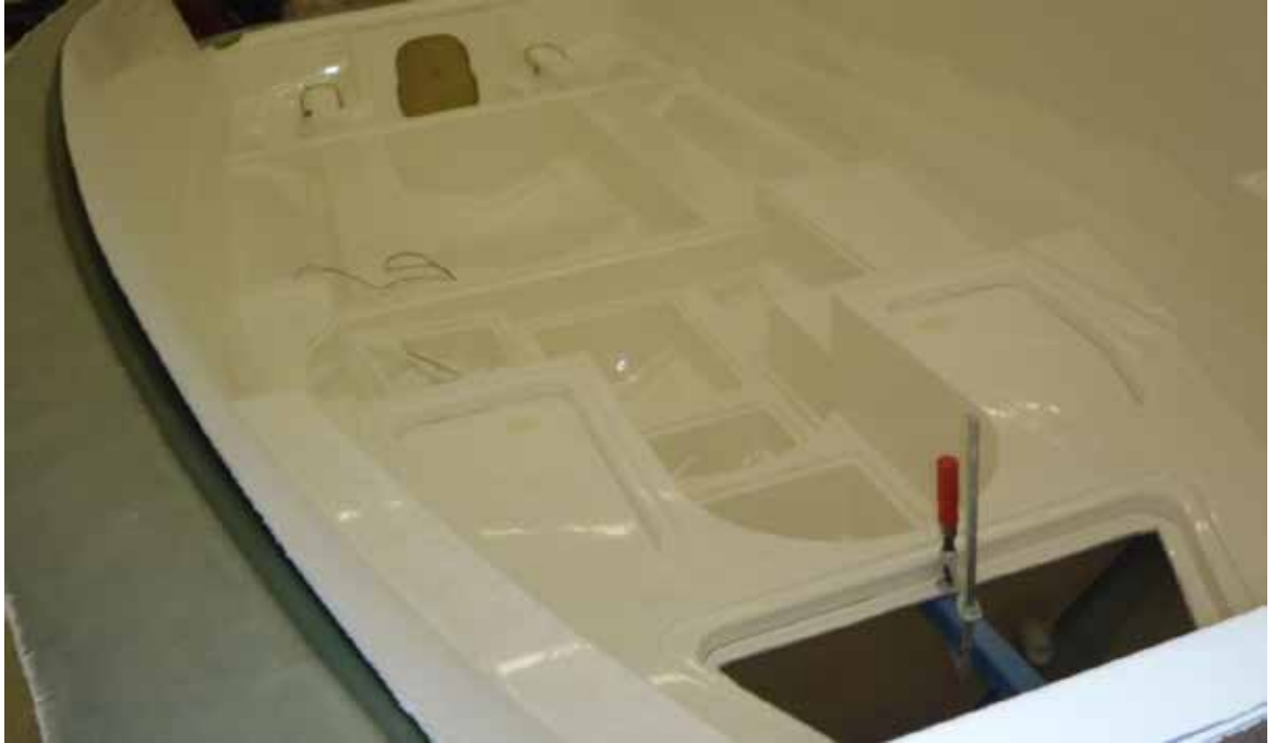
Kuva 16. Veneen runkoon liimattu sisämoduuli.
