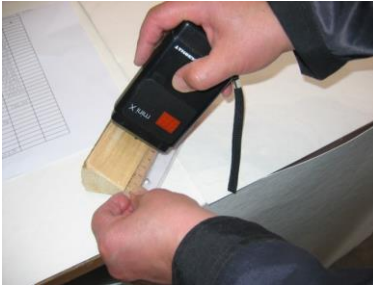
Näytepilkkeen halkaiseminen ja kosteuden mittaaminen piikkimittarilla halkaistulta pinnalta.
