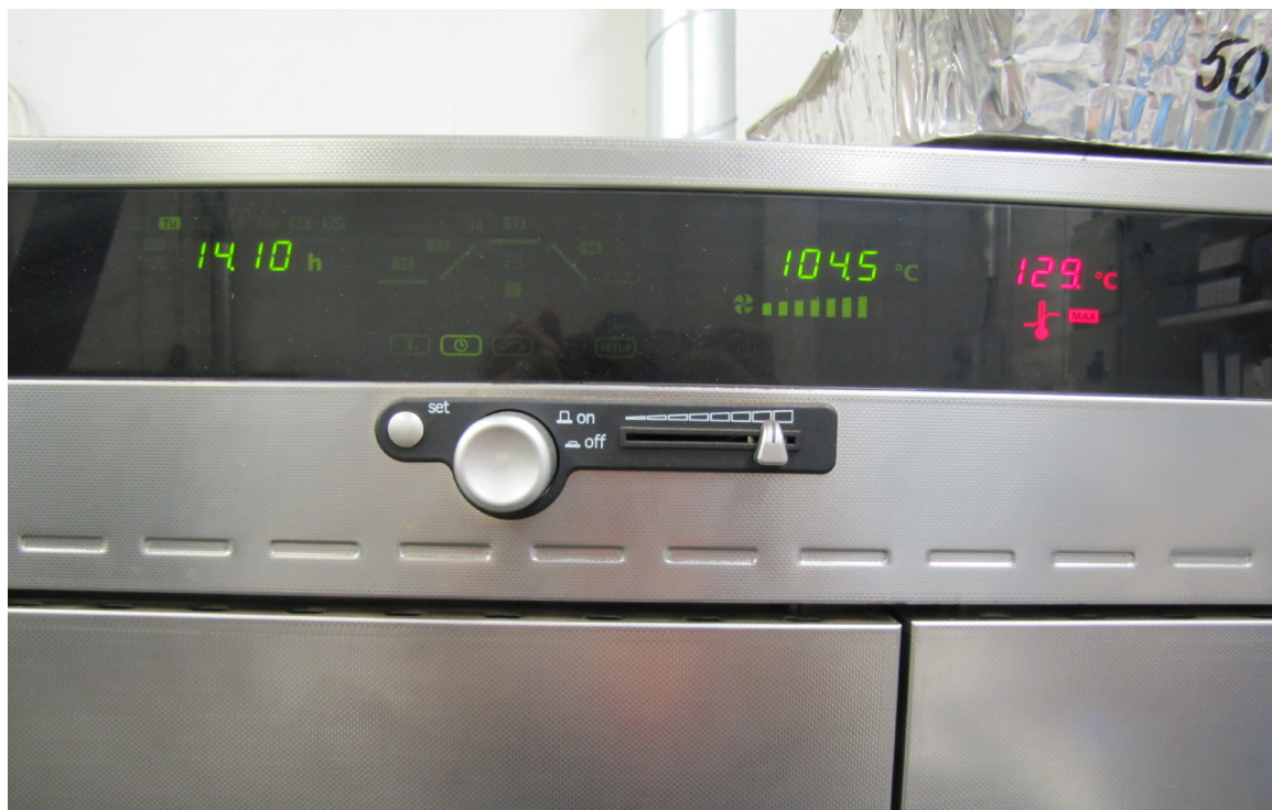
Kuva 2. Lämpötilan tarkkailu lämpökaapissa. Kuva Labtium Oy.
