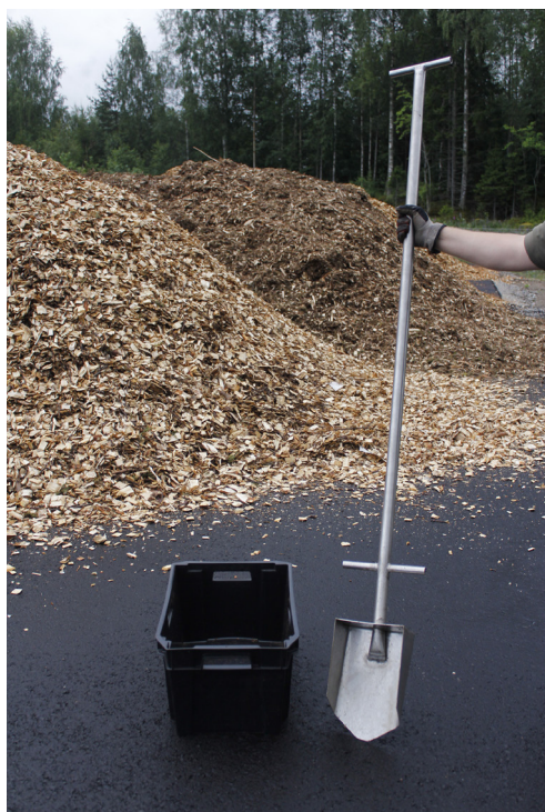
Kuva 2. Kuvassa on lapiomallinen näytteenotin polttoainekasasta tapahtuvalle näytteenotolle. Kuva Haklog ky
