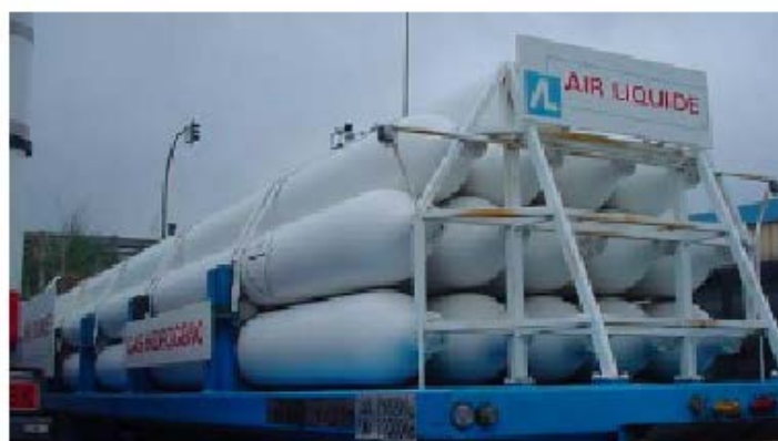
Kuva 3.3. Kaksi mallia paineistetun vedyn kuljetusjärjestelmästä [Air Liquide 2012]. a. pullopatteri, lukumäärästä riippuen 2000–3000 Nm 3 H 2 b. komposiittisäiliöt, kapasiteetiltaan 6200 Nm 3 H 2 .
